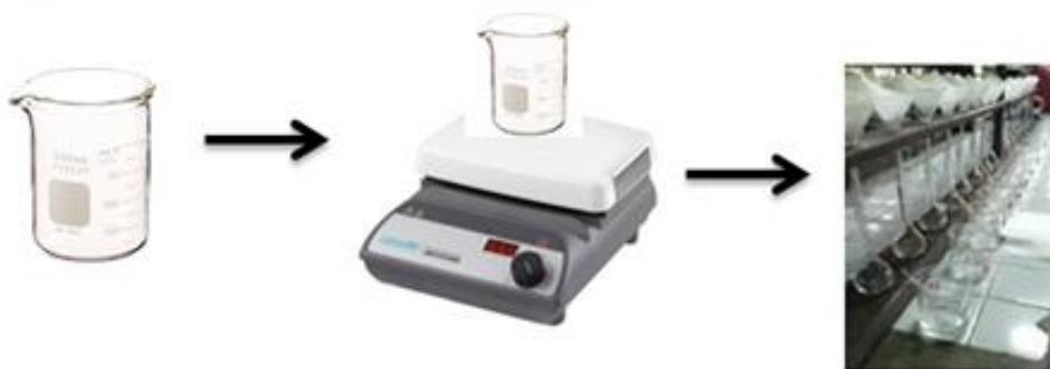
**Figura N° 16** Esquema de digestión de la muestra.
