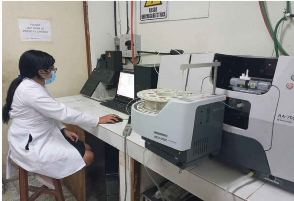
**Figura N° 32** Análisis de las muestras de agua para la determinación de Plomo.
