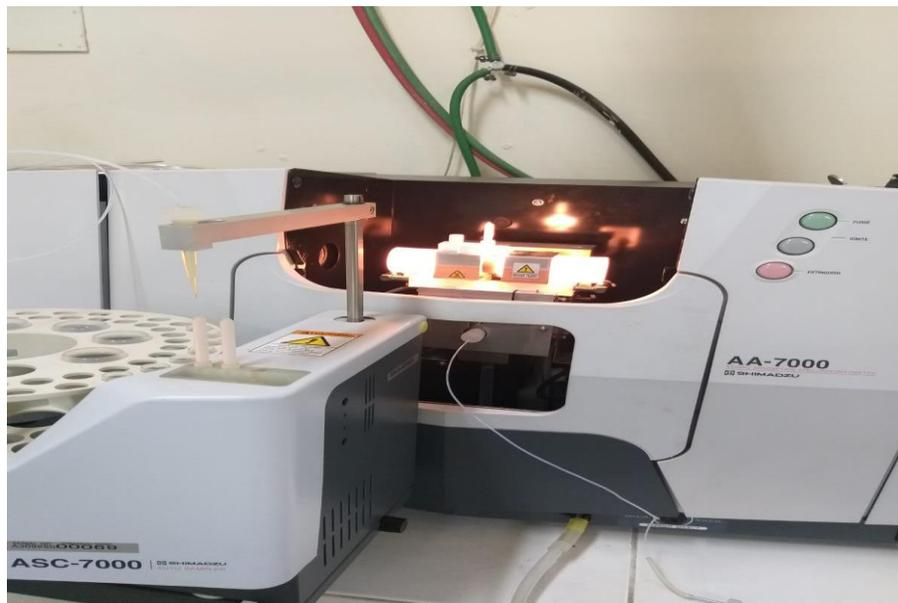
**Figura N° 33** Procedimiento de la etapa de quemado de la muestra de Plomo.
