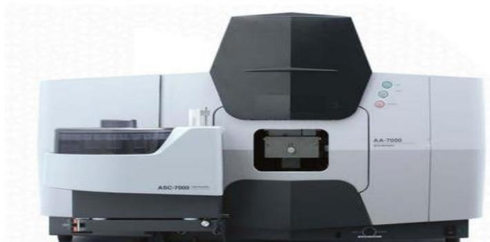
**Figura N°3** Espectrofotómetro de Absorción Atómica Shimadzu AA7000
