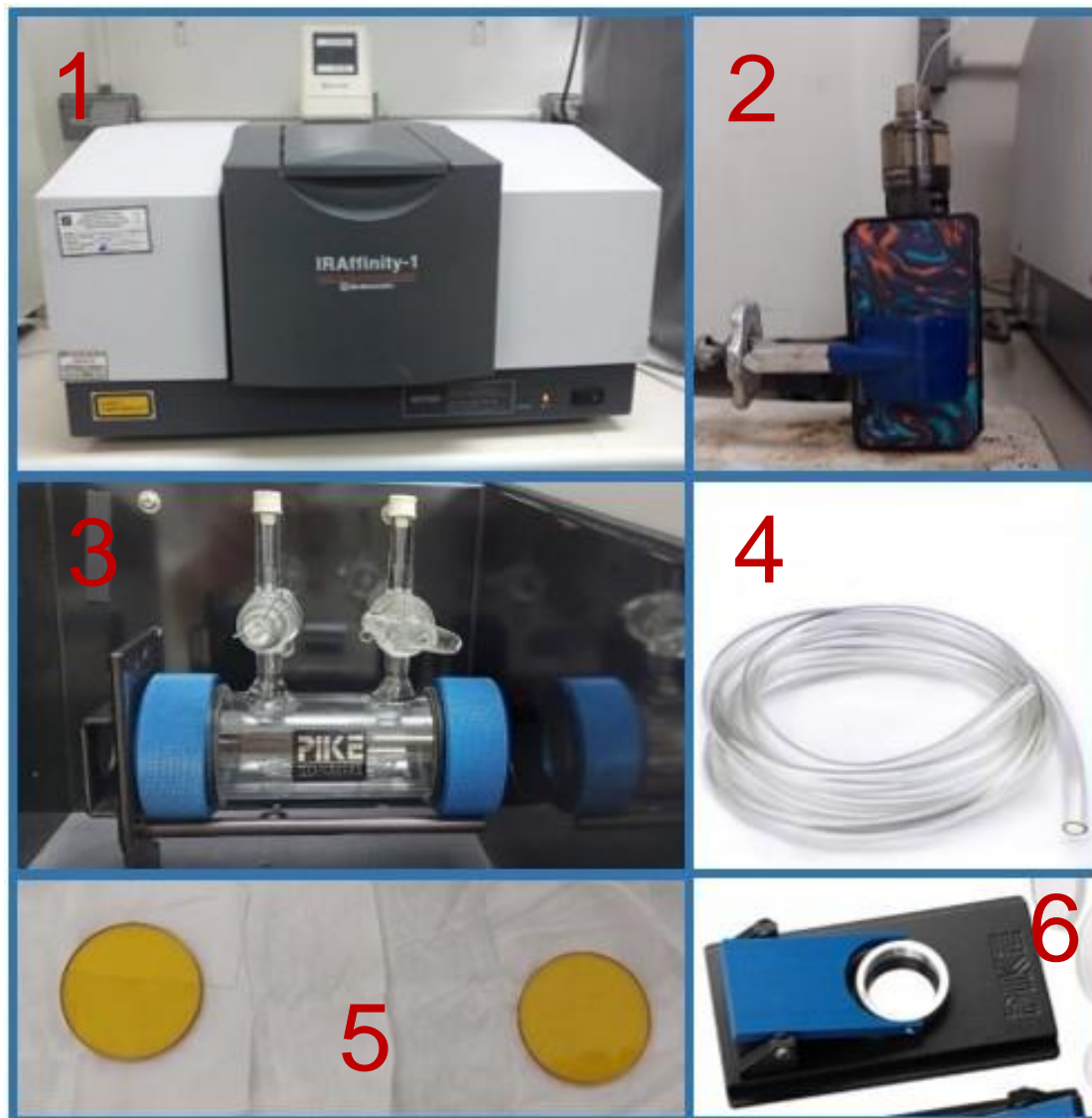
Figura N° 49. Materiales utilizados en el armado del sistema de transmisión por espectroscopia infrarroja en fase gaseosa: 1) Espectrofotómetro Infrarrojo Shimadzu IRAffinity-1, 2) Cigarrillo electrónico, 3) Celda de gases de corto recorrido, 4) Mangueras para la entrada y salida de vapor, 5) Ventanas de Seleniuro de Zinc (ZnSe), 6) Soporte universal para muestras líquidas.
