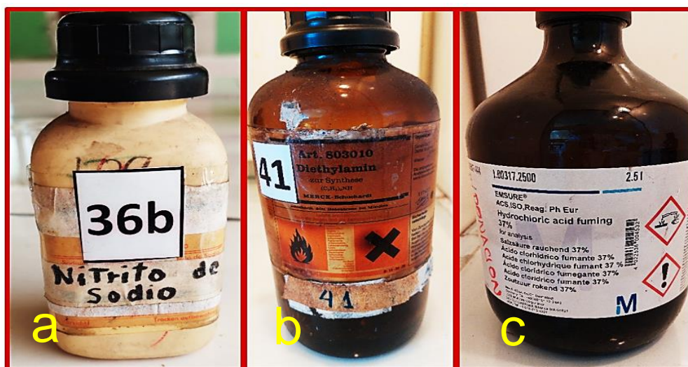
Figura N° 55. Reactivos utilizados en la síntesis de la Nitrosodietilamina: a) Nitrito de Sodio, b) Dietilamina y c) Ácido Clorhídrico concentrado.
