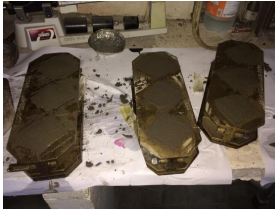
FIGURA 119. Formaletas en ambiente apropiado para reposar
