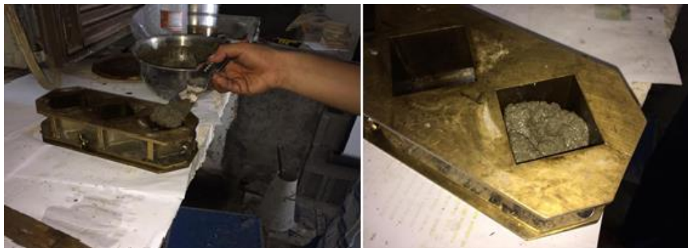
FIGURA 114. Llenando moldes con mortero
