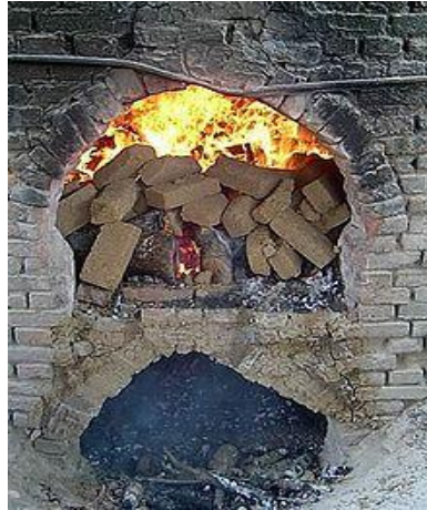
FIGURA 13. Ladrillos siendo incinerados para producir cenizas de carácter puzolánico
