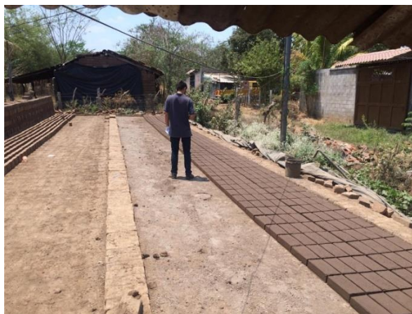
FIGURA 43. Ladrillo fresco antes de ser llevado al horno
