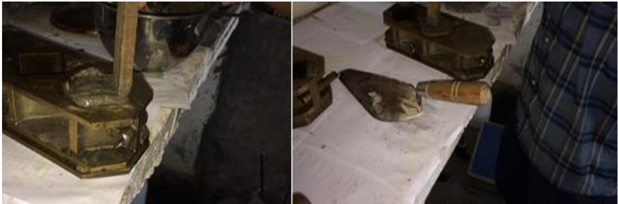
FIGURA 117. Compactación de segunda capa
