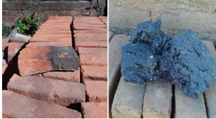
FIGURA 56. Ejemplos de ladrillos calcinados y fundidos, sometidos a temperaturas mayores de 1150 °C
