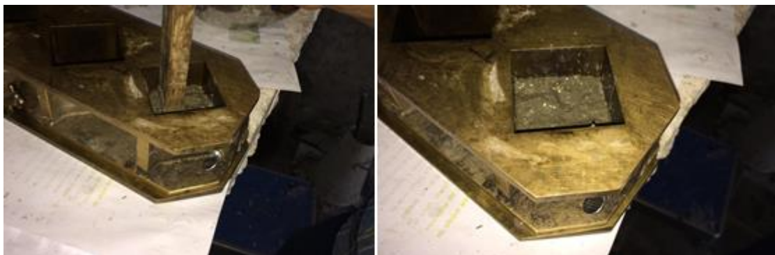
FIGURA 116. Apisonamiento de mortero
