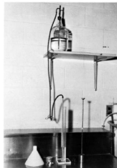
Fig 4. Cilindro Graduado, Tubo de Regador, Ensamblado de Pie Ponderada, y Sifón
