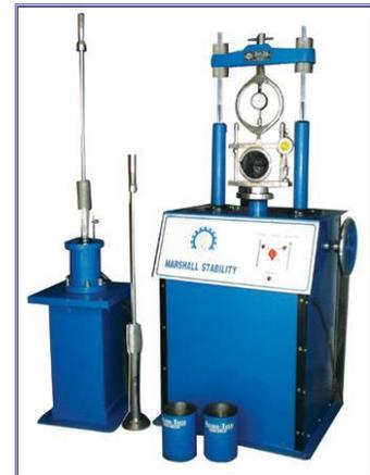
Una de las virtudes del método Marshall es la importancia que se asigna a las propiedades densidad/vacíos del material asfáltico. Este análisis garantiza que las importantes proporciones volumétricas de los componentes de la mezcla estén dentro de rangos adecuados para asegurar una mezcla durable. Desafortunadamente una de sus grandes desventajas es el método de compactación de laboratorio por impacto el cual no simula la densificación de la mezcla que ocurre bajo tránsito en un pavimento real.
