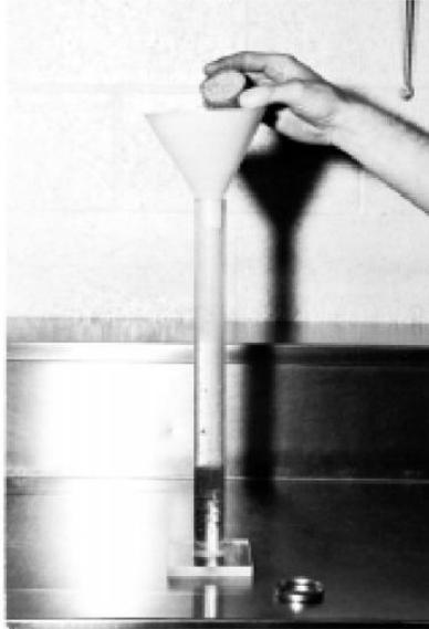
Fig. 5 Transferencia de Muestras de Medir Lata a Cilindro
