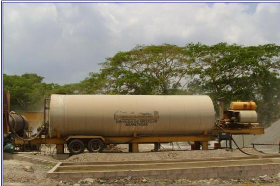
TANQUE PARA ALMACENAMIENTO DE ASFALTO
