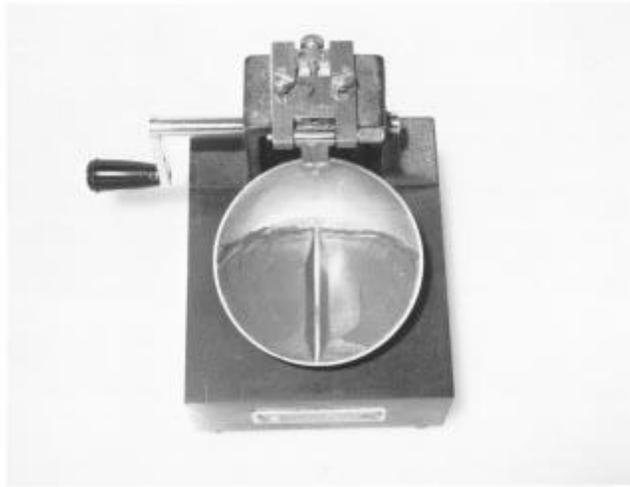
Fig. 6 Dar Palmadita a Suelo Acanalado en Dispositivo de Límite Líquido
