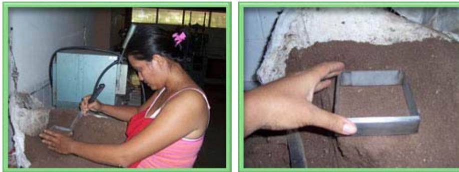
Figura 112. Preparación de los especímenes para ensayo de corte.
