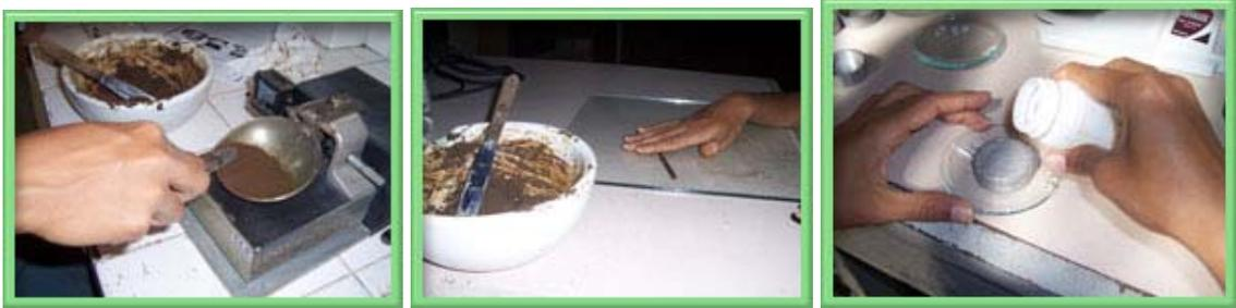
Figura 109. Determinación de los límites de consistencia de los suelos.
