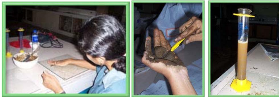
Figura 107. Realización del ensayo de descripción visual-manual de los suelos.
