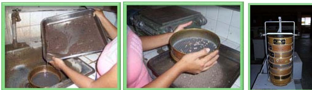
Figura 108. Realización del ensayo de análisis granulométrico de los suelos.
