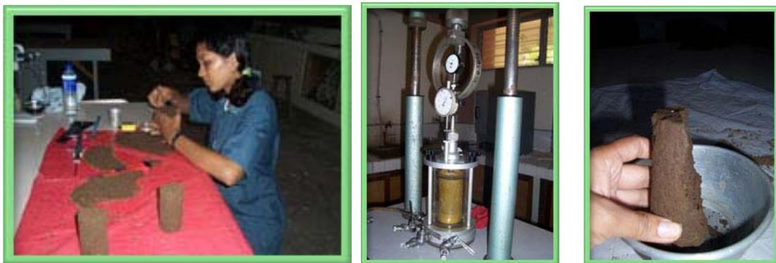
Figura 111. Ensayo Triaxial consolidado no drenado.
