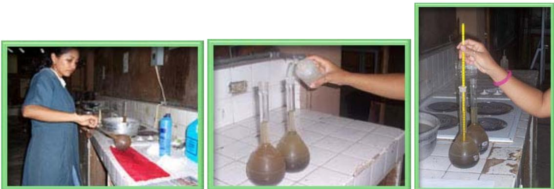
Figura 110. Determinación de la gravedad específica de los sólidos los suelos.
