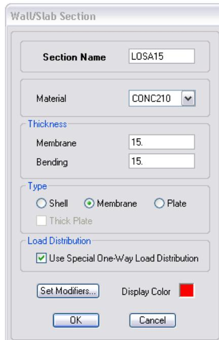
Figura 5.2.22 b. Definición de losa de escaleras.
