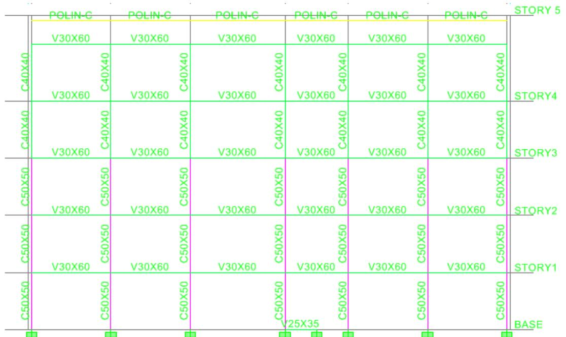
Figura 6.4.4 Vista en elevación del eje "3" del Sistema de Dual.
