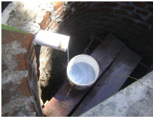
Fig. 3.36 Medición de caudal en punto de descarga.
