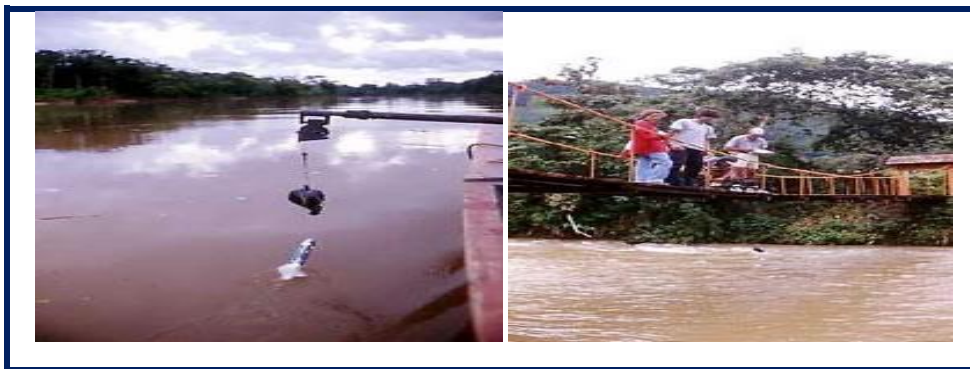
Figura N o 3.2.7.3: Correntómetro suspendido desde un bote y desde un puente. Fuente: Servicio Nacional de Estudios Territoriales (SNET)
