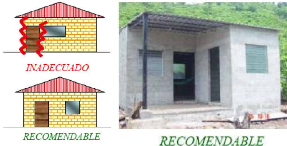
Figura N° 5.4.1.5: Control en el ancho de aberturas.
