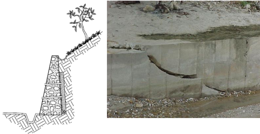
Figura N° 5.1.1.2: Muros de concreto ciclópeo.
