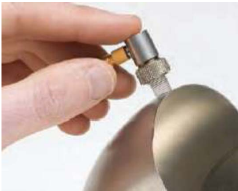
Fig. 1.13. Forma de uso de un palpador de línea retrasada.
