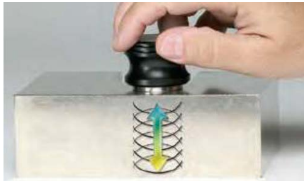
Fig. 1.9. Representación de cómo se propagan las ondas ultrasónicas en la pieza analizada.
