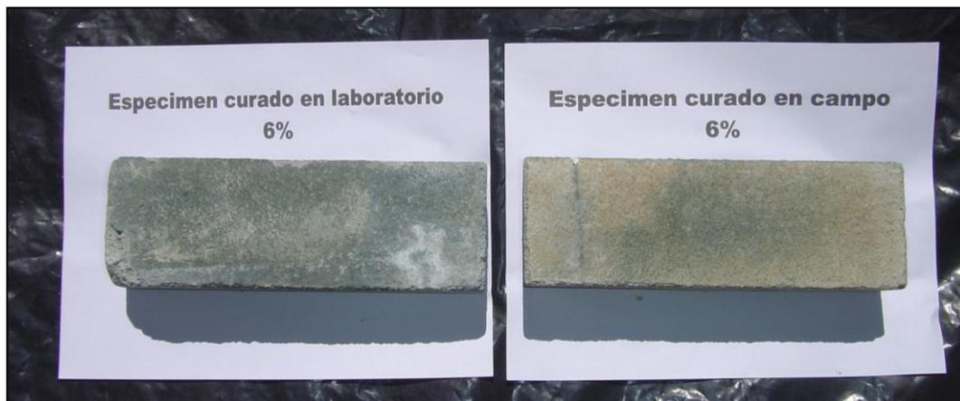
*Fig 37. Comparación de especimenes hechos con de cemento blanco, pigmentados al 6%.*
