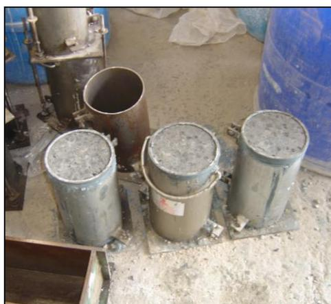
*Fig 43. Especímenes cilíndricos de concreto*
