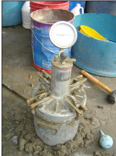
*Fig 6. Aparato para la medición del contenido de aire de una mezcla de concreto, según la especificación ASTM C-231 "Método de Presión", también se puede apreciar la pipeta para la introducción de agua al recipiente. Este fue el aparato que se utilizará para la determinación del contenido de aire en la realización de este estudio.*
