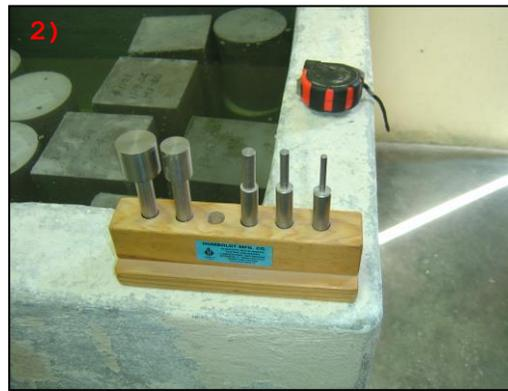
*Fig 9.1) Dispositivo para ensayo de tiempo de fraguado, 2) Agujas de punta plana con área de sección transversal circular, utilizadas para medir la resistencia a la penetración según ASTM C-403.*
