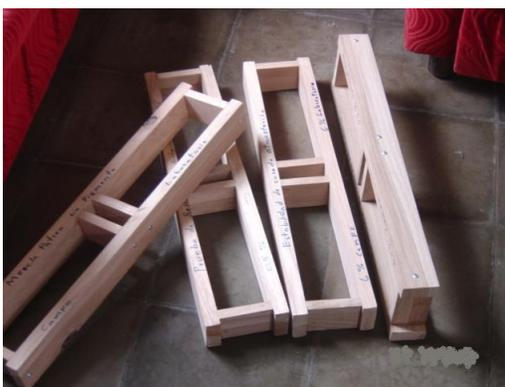
*Fig 29. Moldes de madera para elaboración de especímenes de mortero con medidas de 9"x3"x2"*
