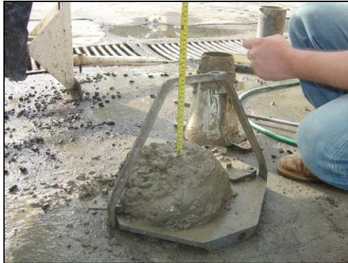
*Fig 41. Medición del revenimiento del concreto fresco*
