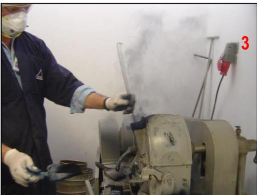
*Fig 28. 1- Maquina pulverizadora de discos, 2- Introducción del añil a la maquina, 3- Pulverización de añil en el laboratorio.*
