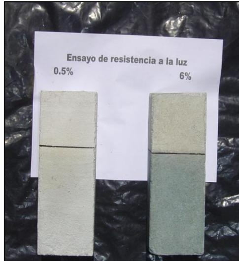
*Fig 38 A. Diferencia en la tonalidad de color en especímenes ensayados a las 500 horas para la resistencia a la luz del mortero pigmentado hecho con cemento blanco.*
