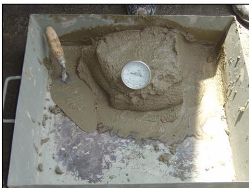
*Fig 46. Toma de temperatura de mortero cribado*
