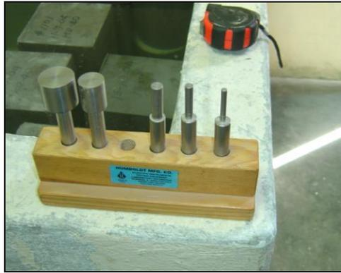
*Fig 47. Agujas utilizadas en ensayo de tiempo de fraguado del concreto*
