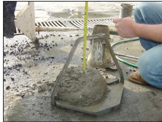
*Fig 3. Prueba de revenimiento para medir consistencia del concreto fresco*
