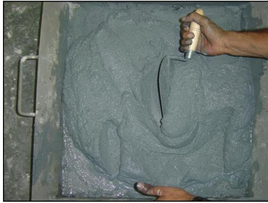
*Fig 36. Mortero hecho a base de cemento blanco coloreado con añil al 6% de pigmento.*
