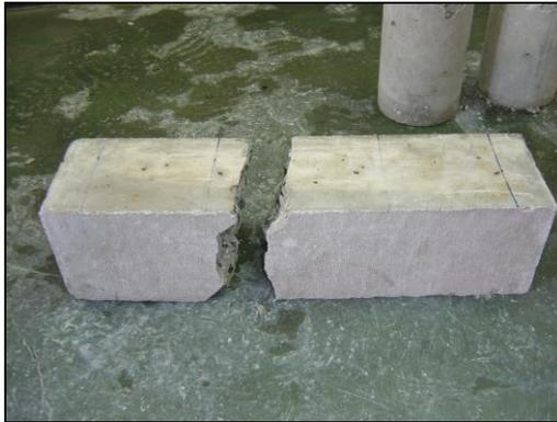
*Fig 44. Viga de concreto marcada y ensayada*
