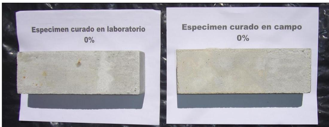
*Fig 34. Diferencia entre especímenes de mortero al 0% de pigmento (mezcla de control), expuestos a diferentes condiciones de curado*
