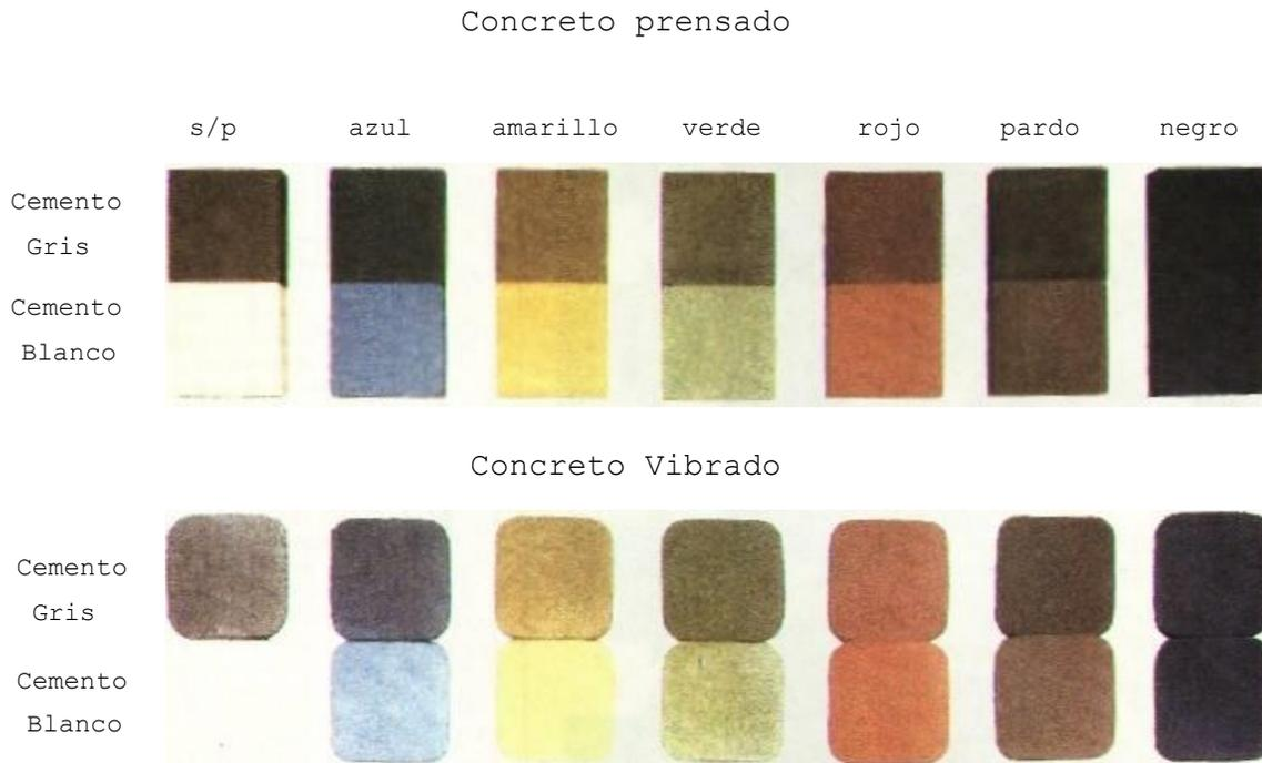
*Fig 14. Diferencia de tonalidades en el concreto coloreado, debido al tipo de cemento utilizado y al método de compactación; en concretos prensados el color tiende a ser mas oscuro por la relación agua/cemento mas baja.*
