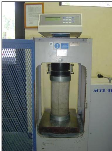
*Fig 49. Ensayo de cilindros de concreto a la compresión.*
