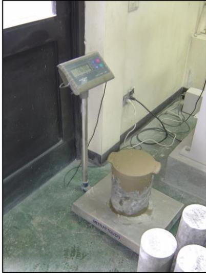
*Fig 5. Peso del concreto en bascula digital de 0.05 Kg de precisión con un recipiente de 14 litros.*
