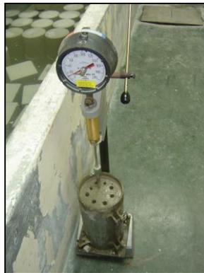
*Fig 48. Aparato para ensayo de tiempo de fraguado*
