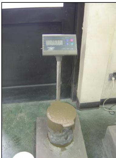
*Fig 39. Determinación del Peso volumétrico del concreto*
