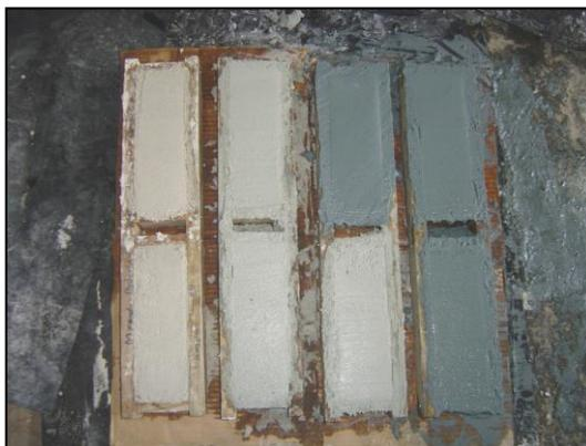
*Fig 32. Especímenes de mortero al 0%, 0.5%, y 6% de pigmento. en moldes de madera.*
