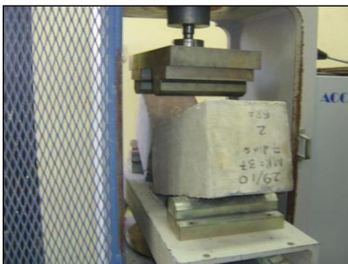
*Fig 45. Ensayo a la Flexión de viga de Concreto*
