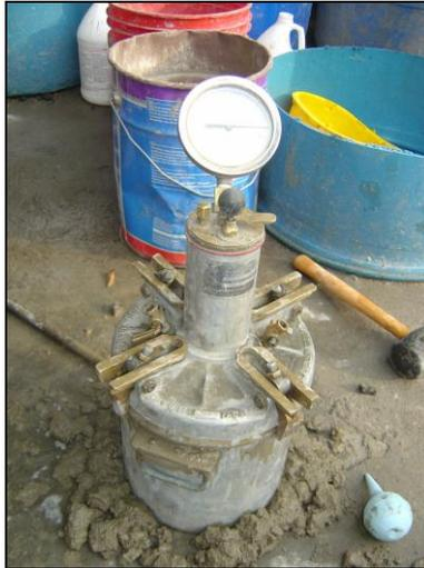
*Fig 42. Ensayo de contenido de aire del concreto fresco. Medidor tipo B*
