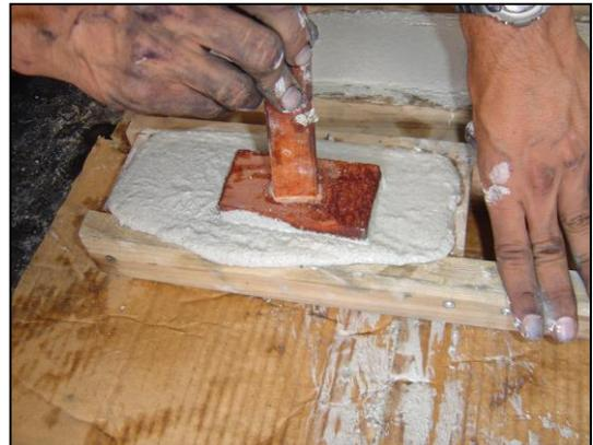
*Fig 31. Compactación de la mezcla de mortero con apisonador de madera de 2" x 4".*
