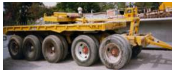
Figura4.3. Modulo direccional de 5 ejes para 65 toneladas
