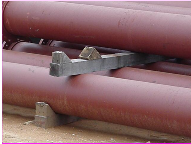
Fig. 56 Almacenamiento de materiales cilíndricos
