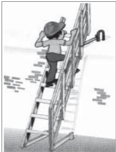
Fig. 75 Escalera con pasamano
