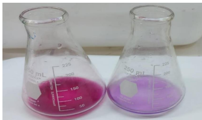
Figura N°6. Demostración de viraje de color al realizar una valoración complejométrica con EDTA 0.05M (a la derecha se observa la muestra inicial y a la izquierda se muestra el punto final)
