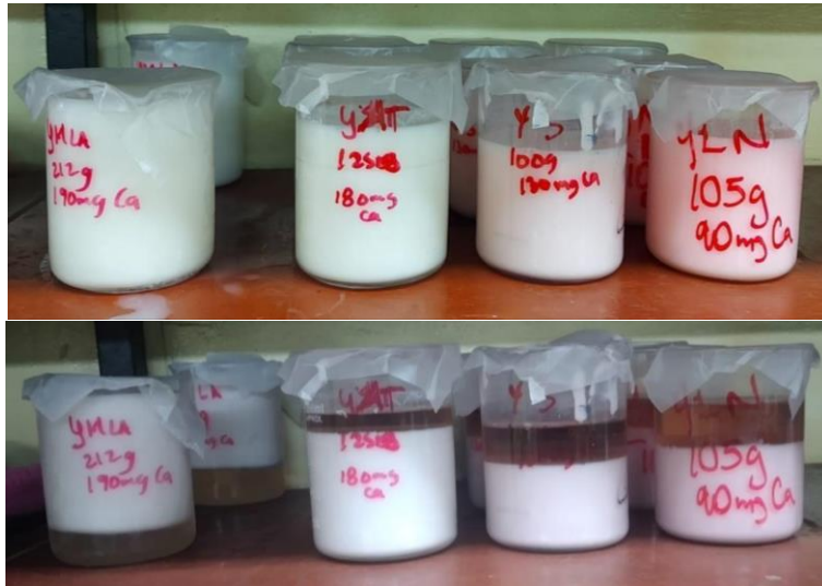
Figura N°7. Tratamiento de muestras para ser utilizadas en el método Oxido-Reducción (muestra más Acido Clorhídrico)
