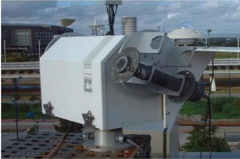
Figura 1-18: Pirheliómetro NIP montado sobre seguidor solar (Daniel Pérez Carrasco. (2018).
