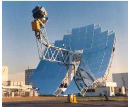
Figura 1-25: Colector solar de foco de punto («Tipos de colectores solares: distintos sistemas para calentar agua», 2018).
