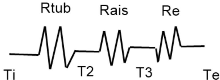
Figura 2-14. Circuito térmico de resistencias en serie para los cálculos de aislamiento en el tanque de almacenamiento.
