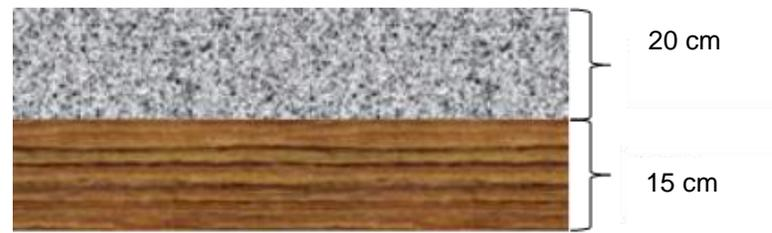
*Figura 4.13. Estructura del pavimento rígido calculada por WinPas 12.
