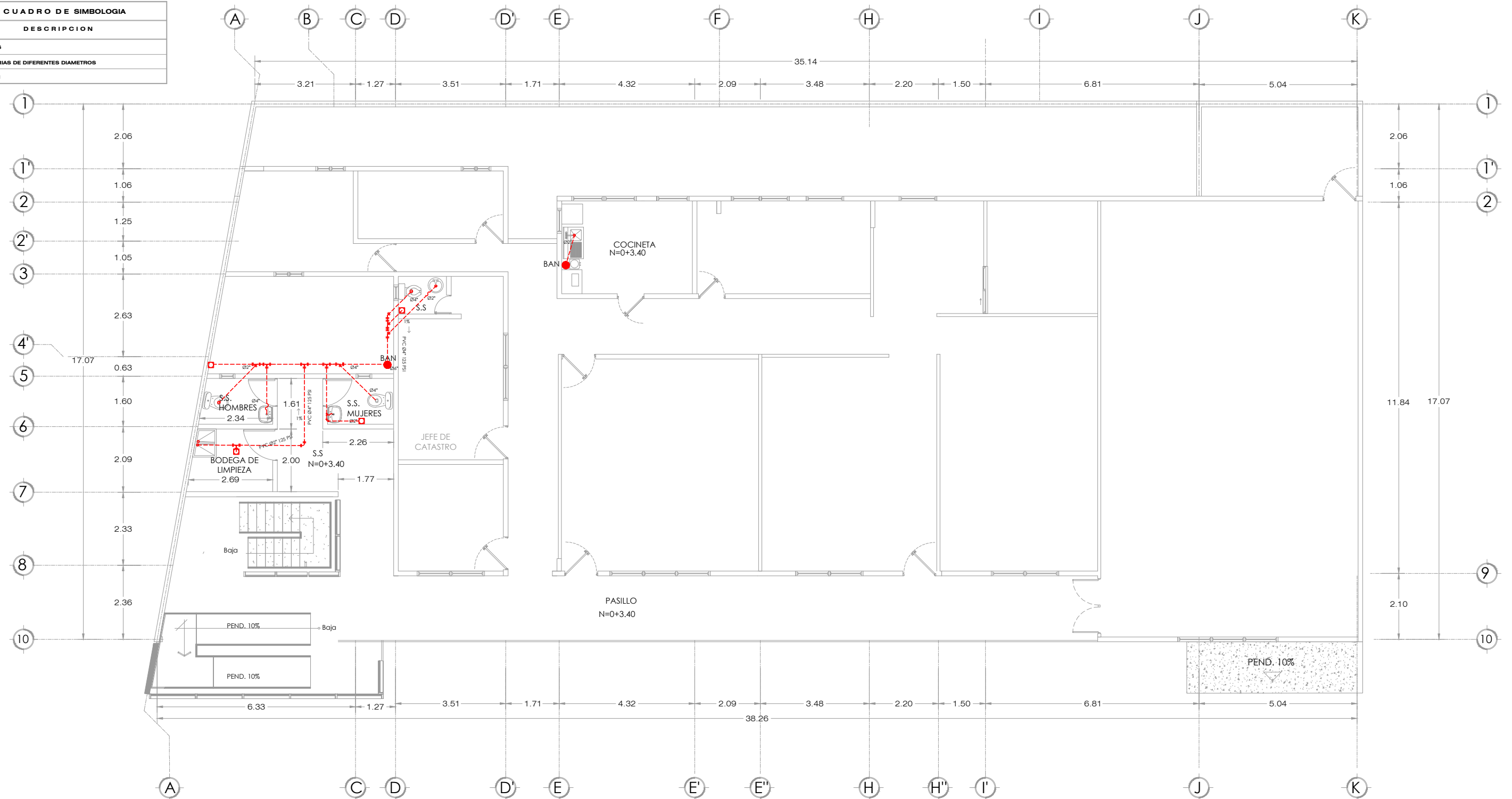
PLANTA DE AGUAS NEGRAS Segundo Nivel Esc. 1:125
