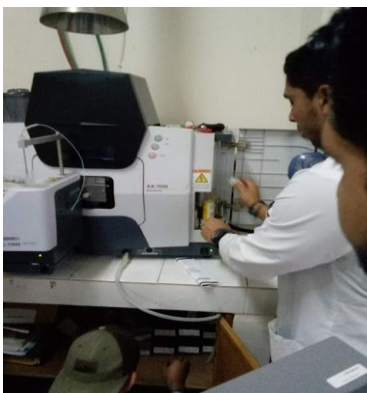
Figura 5. Determinación de minerales por AA de llama.
