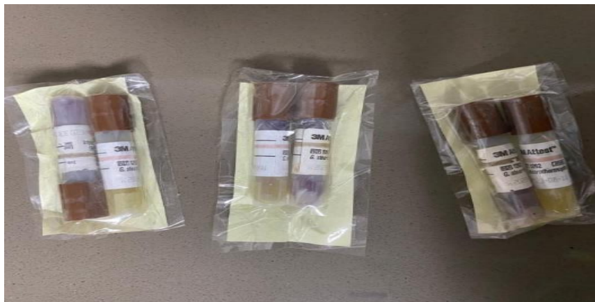
Figura N°48. Testigo del Test de Prueba Geobacillus stearothermophilus utilizado en los controles de calidad en la esterilización de los DBI.
