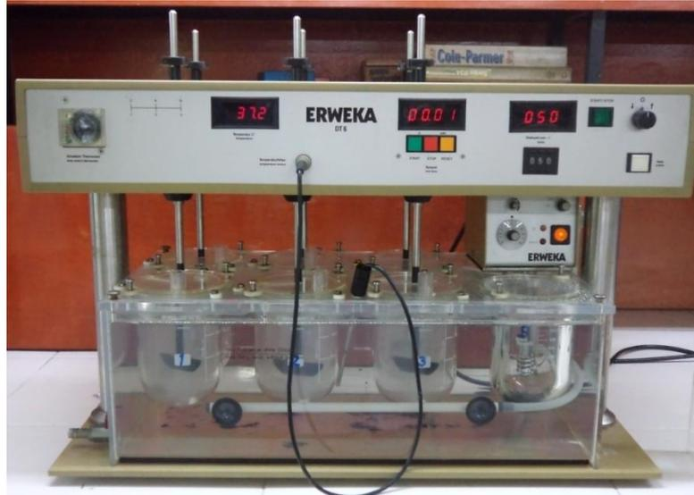
Figura N°49. Equipo utilizado para Disolución de tabletas de Acetaminofén 500mg e Ibuprofeno 600 mg. (Aparato 2: Paletas).
