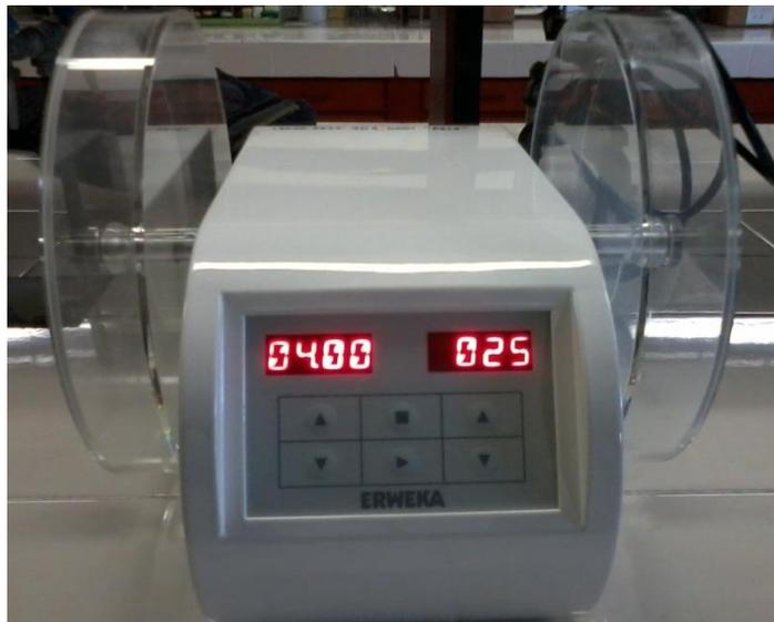
Figura N°50. Equipo utilizado para la determinación de la Friabilidad en tabletas de Acetaminofén 500 mg e Ibuprofeno 600 mg (Friabilizador).
