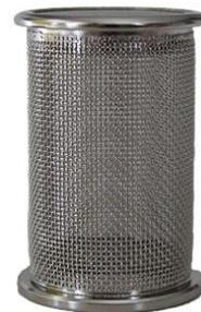
Figura N°48. Equipo de Disolución. Aparato 1: Canastilla.
