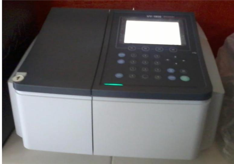
Figura N°47. Espectrofotómetro UV-Visible utilizado en la Identificación y Valoración de Principio activo en tabletas de Acetaminofén 500 mg e Ibuprofeno 600 mg.
