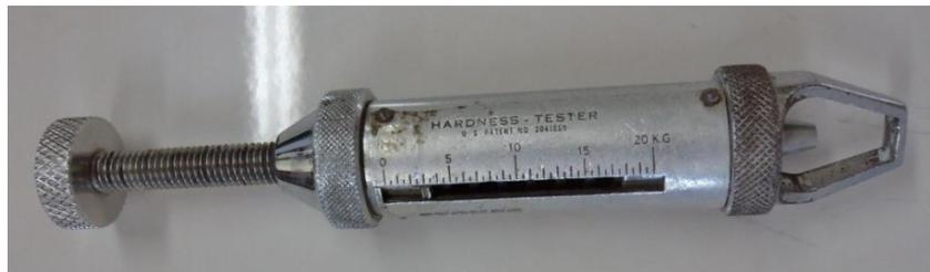
Figura N°54. Durómetro utilizado para la determinación de Dureza en tabletas de Acetaminofén 500 mg e Ibuprofeno 600 mg.
