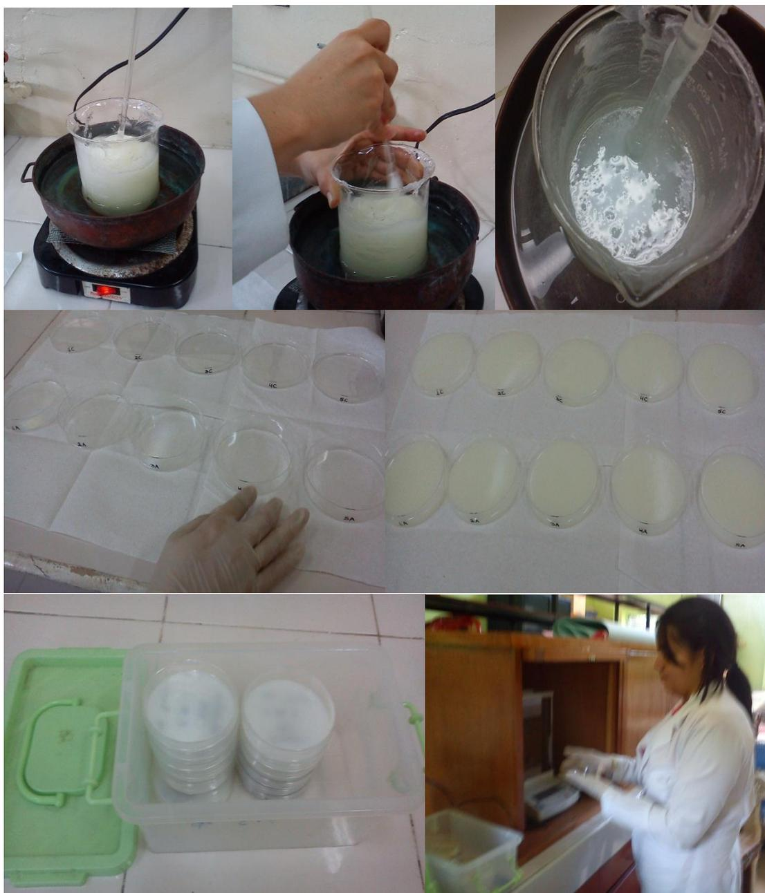
Figura N° 21 Preparación de las Placas Receptoras
