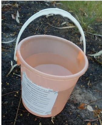
Figura N° 11 Dispositivo para el Muestreo de PAS, en época seca Método de Bergerhoff
