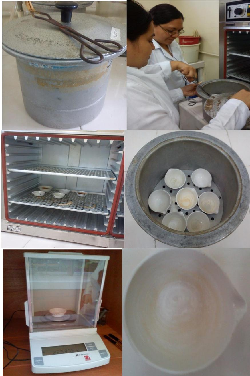
Figura N° 16 Cuantificación en la muestra de Polvo Atmosférico Sedimentable (PAS) por el método de Bergerhoff.
