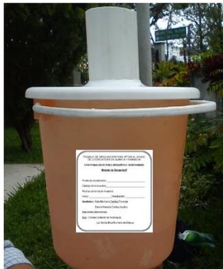
Figura N°12. Frasco recolector de muestras con restricción de diámetro superior.
