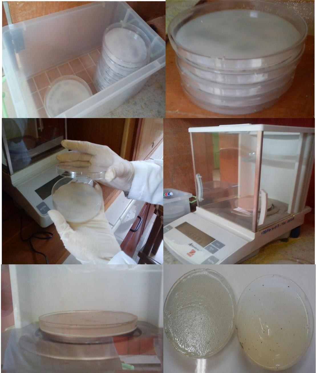
Figura N° 23 Cuantificación de Polvo Atmosférico Sedimentable (PAS), mediante el Método de Placas Receptoras
