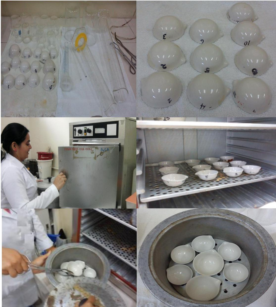
Figura N° 14 Preparación de las cápsulas de porcelana para la cuantificación de Polvo Atmosférico Sedimentable (PAS)
