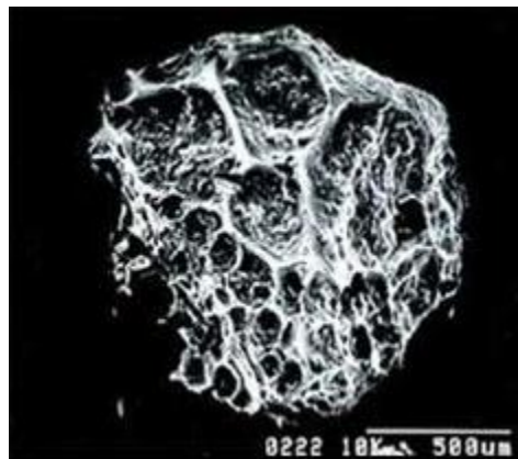
Figura n°17: Porosidad de un carbón activado
