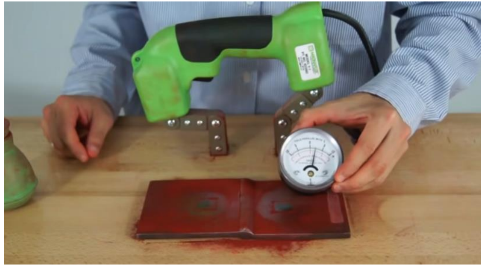
Fig. 3.5. Existencia de magnetismo en la superficie de la placa de acero [9].
