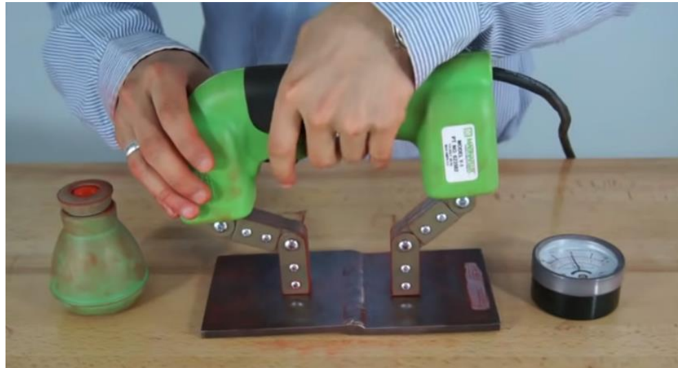
Fig. 3.2. Inducción del campo magnético a través del Yugo [9].
