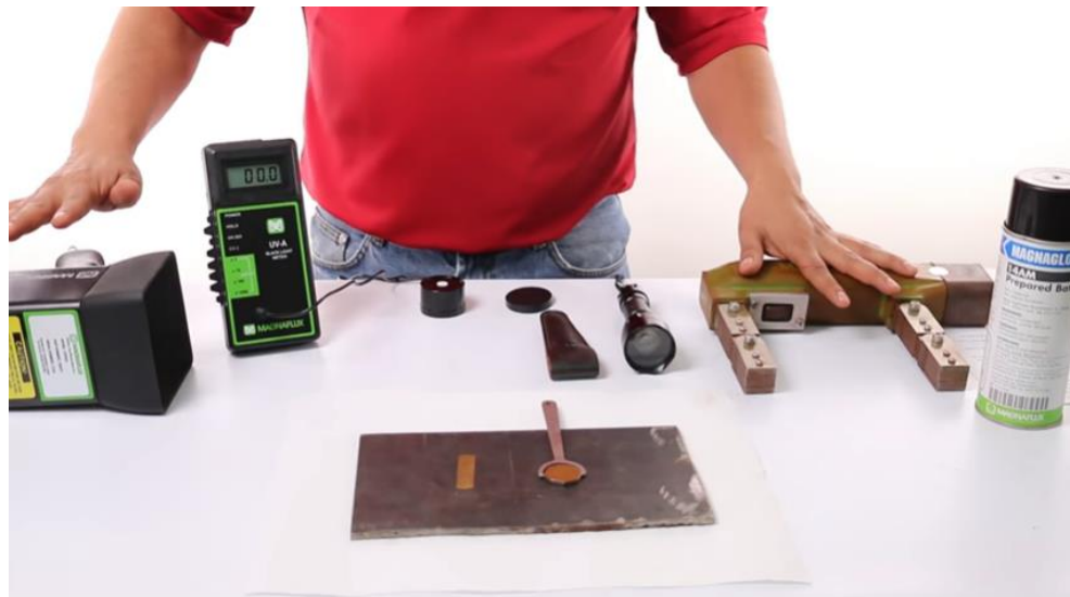
Fig. 3.12. Elementos para la realización del estudio con partículas húmedas fluorescentes [11].
