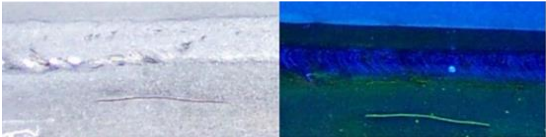
Fig. A.6. Comparación entre partículas fluorescentes y visibles.
