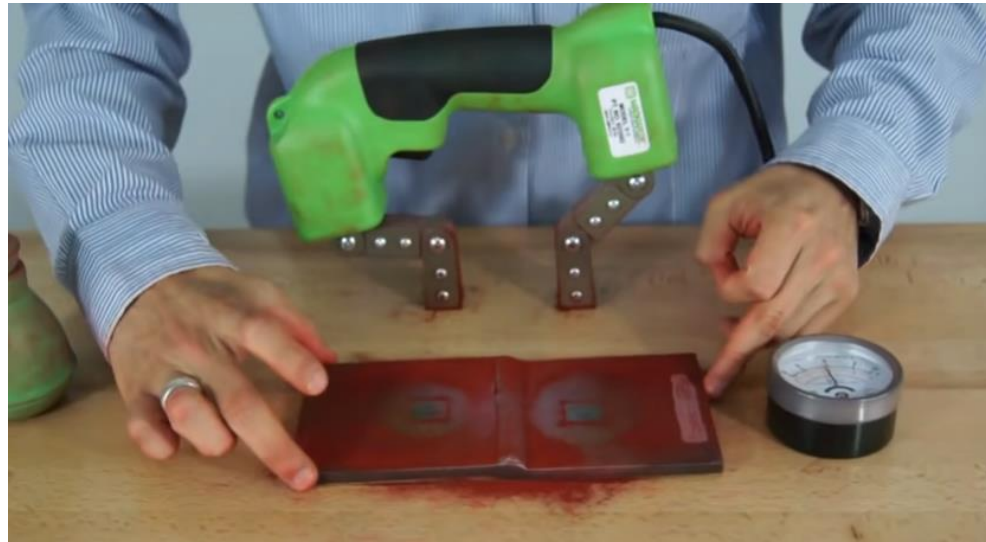
Fig. 3.4. Creación de líneas de campo [9].
