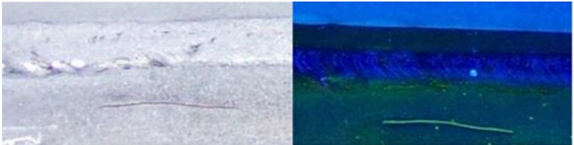
Fig. 2.7. Comparativa entre partículas fluorescentes y visibles [8].
