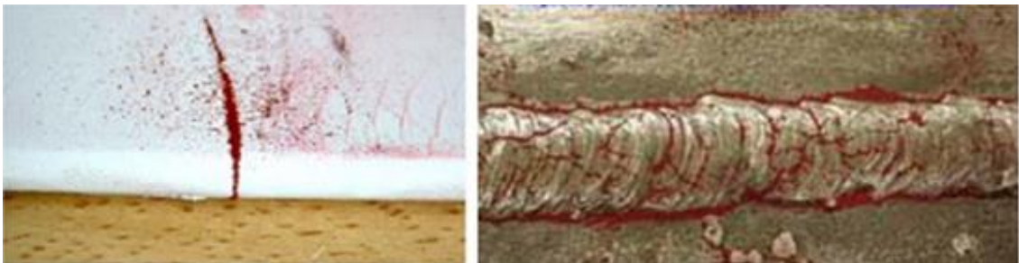
Fig. A.4. Grieta visualizada a través de partículas secas rojas.
