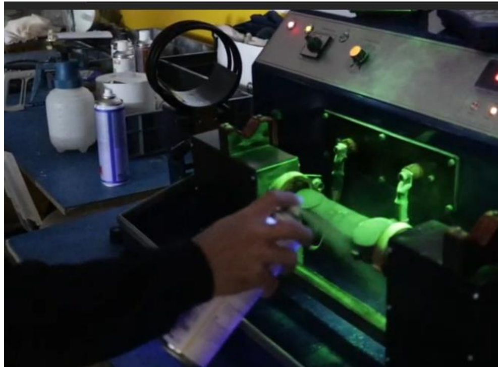
Fig. 3.10. Añadidura de partículas magnéticas e inyección de corriente a la pieza [10].
