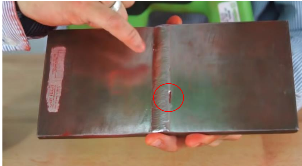
Fig. 3.7. Fisura encontrada realizando el ensayo de partículas magnéticas [9].
