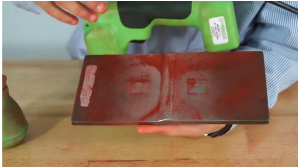
Fig. 3.6. Campo longitudinal continuo en la superficie [9].
