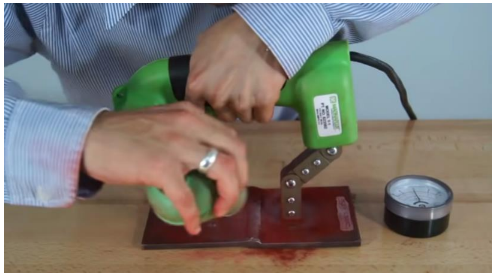
Fig. 3.3. Añadidura de partículas magnéticas [9].
