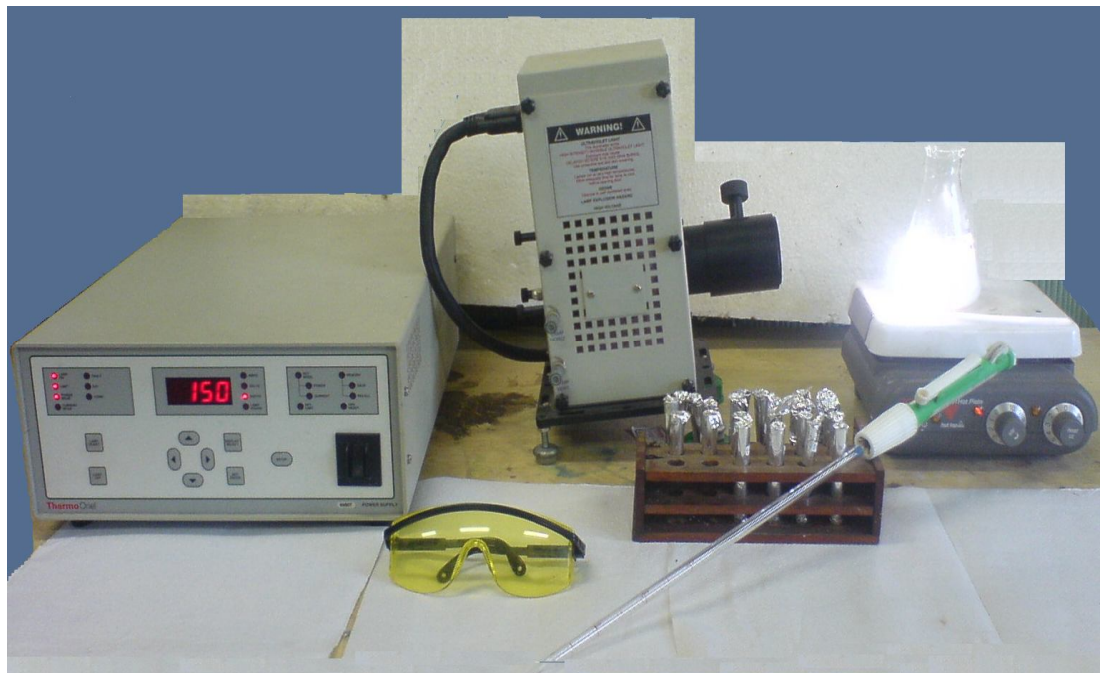
Figura Nº 30: Irradiación de luz ultravioleta utilizando una lámpara de arco de Xenón de alta presión de 150 Watts
