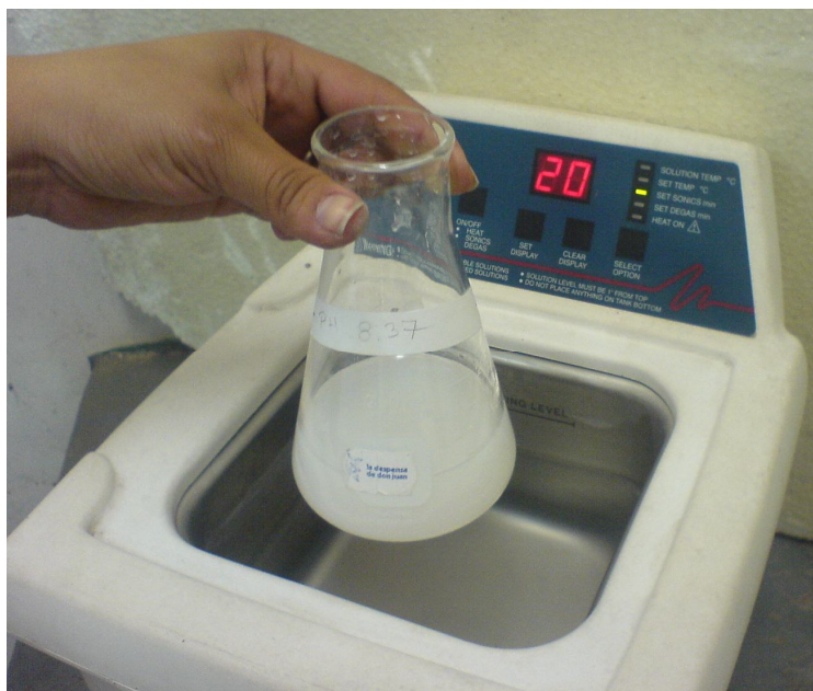
Figura Nº 29: Disminución del tamaño de partículas de ZnO en el ultrasonido
