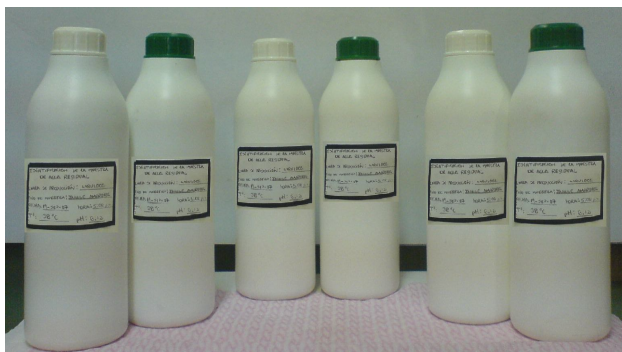
Figura N° 8: Muestreo de aguas residuales de producción del laboratorio farmacéutico. Los frascos con tapadera blanca son las muestras para los análisis previos al tratamiento fotocatalítico y los frascos con tapadera verde son las muestras para el tratamiento fotocatalítico y análisis posteriores.
