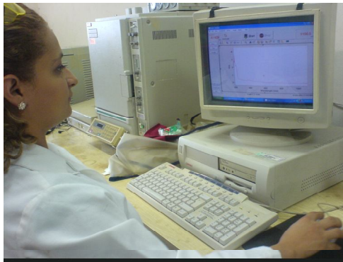
Figura N° 32: Toma de espectros UV-VIS en espectrofotómetro Cary 50 de las alícuotas centrifugadas.
