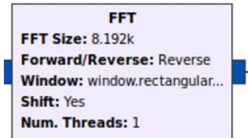
*Figura 53 Boque para realizar la transformada e Fourier en GNU Radio.*
