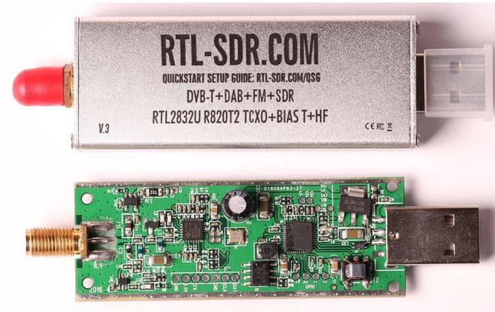
*Figura 18 Dispositivo RTL-SDR utilizado para implementación del receptor ISDBT*
