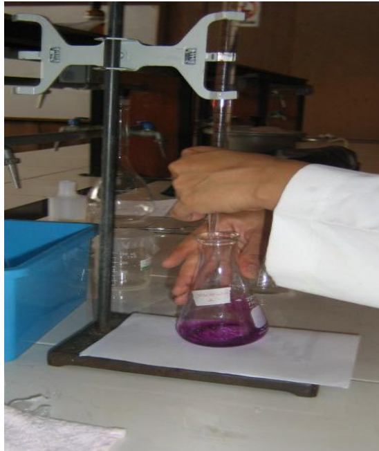
Fig. No.14 Determinación de Dureza.
