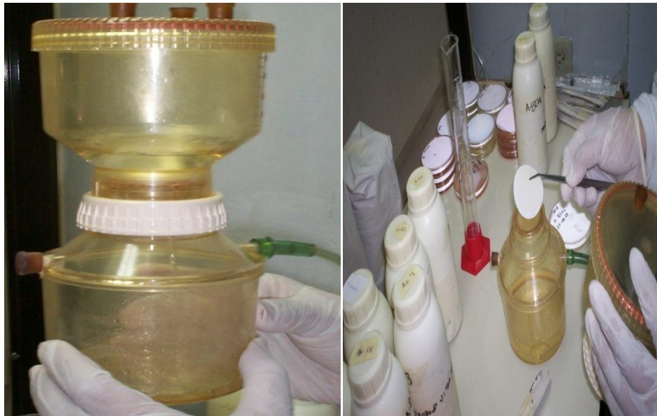
Fig. No. 17 Equipo para el Método de Filtración por membrana
