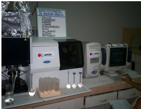
Fig. No. 15 Espectrofotómetro de Absorción Atómica para análisis de metales
