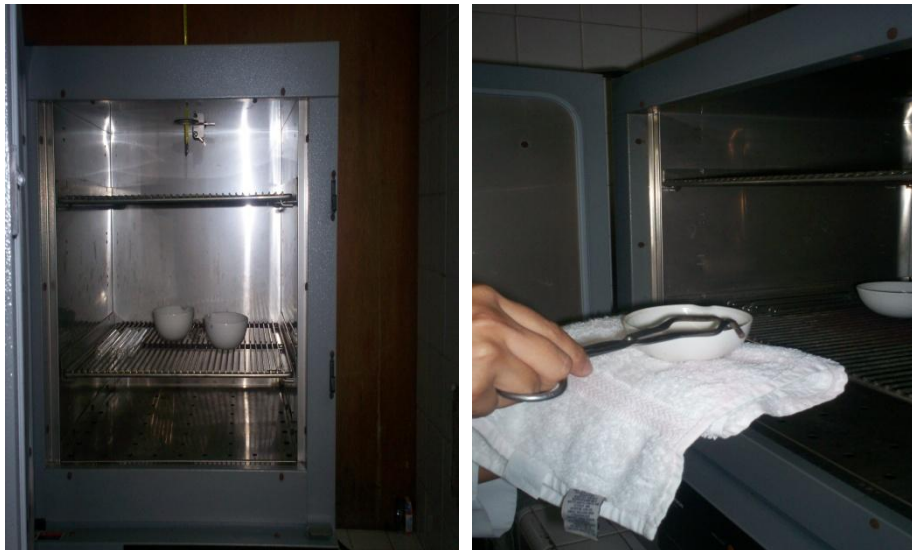
Fig. No. 13 Determinación de Sólidos Totales a 103-105 °C.
