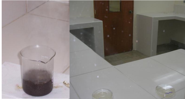
Figura N° 12: Descontaminación y comprobación de la descontaminación del área de trabajo. La imagen del lado izquierdo muestra el instante en el que se desprenden los gases de formaldehído. La imagen del lado derecho presenta la ubicación de las placas de petri de Trypticasa Soya Agar (TSA) y Agar Papa Dextrosa (APD).
