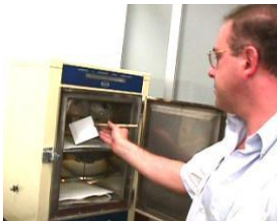
FIG N° 15: Secado de la placa cromatografica
