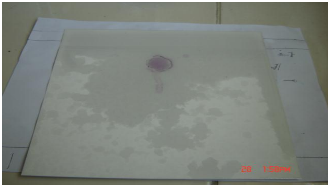
FIG N°29: Localización de alcaloides esteroidales en placa cromatográfica (muestra de extracto alcohólico)
