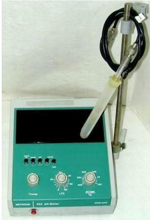
Fig. N° 23: Metrohm 632 pH meter modelo de mesa, utilizado para la medición de pH por medio de un electrodo.
