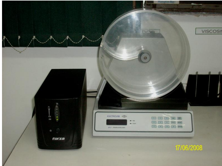
Fig. No 3: Friabilizador, Marca: Electrolab, Modelo: EF-2
