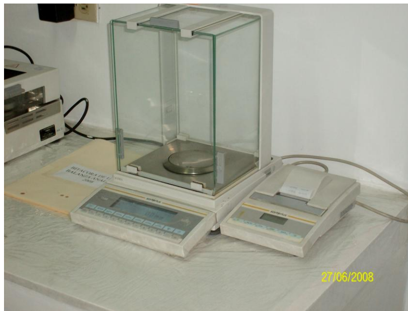
Fig. No 6: Balanza Analítica; Marca: Sartorius; Modelo: LA230S; Serie:
