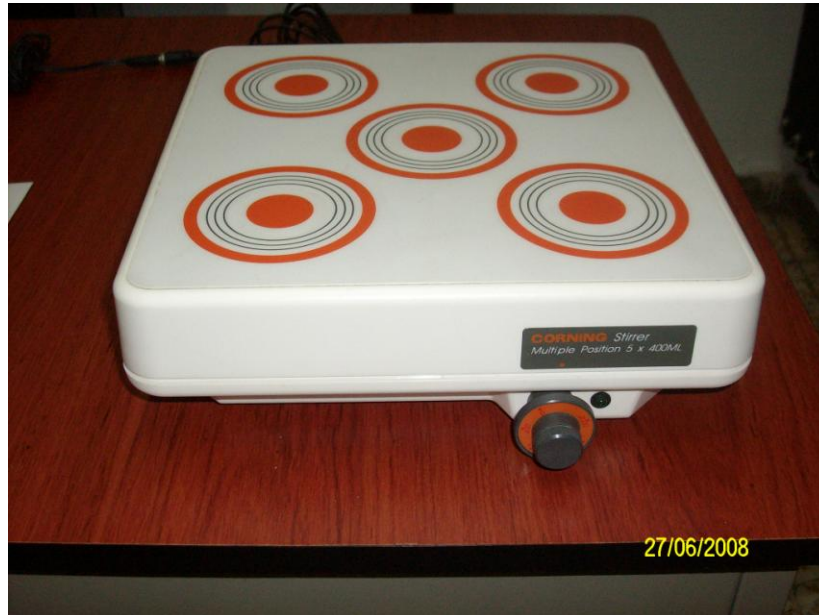
Fig. No 5: Agitador Magnético, Marca: Corning, Modelo: Multiple Position 5
