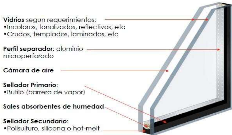
Figura 1.4. Sistema de Doble Vidriado Hermético (DVH).
