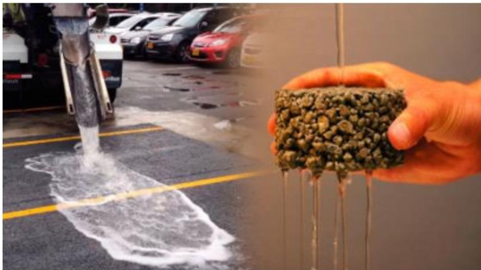
**Ilustración 2.12.** Ejemplo del funcionamiento de un pavimento permeable, fuente base de datos Google imágenes, civilgeeks.com (2016).
