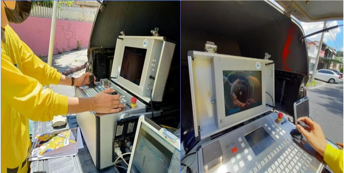
**Fotografía 4.9** Control del equipo de inspección mientras está dentro de un tramo de tubería por medio del panel de control. Fuente: Elaboración propia.
