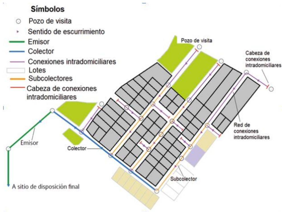
**Ilustración 2.6.** Trazo conceptual de los componentes de una red de drenaje pluvial, fuente imagen retomada y modificada de (CONAGUA, 2019).
