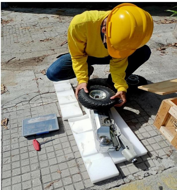
**Fotografía 4.4** Instalación de neumáticos en tractor, proceso de preparación para la inspección. Fuente: Elaboración propia.
