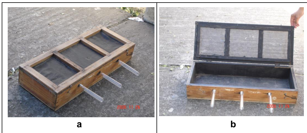
Fig. 17. Cámaras de recuperación: (a) Vista exterior; (b) Vista interior.
