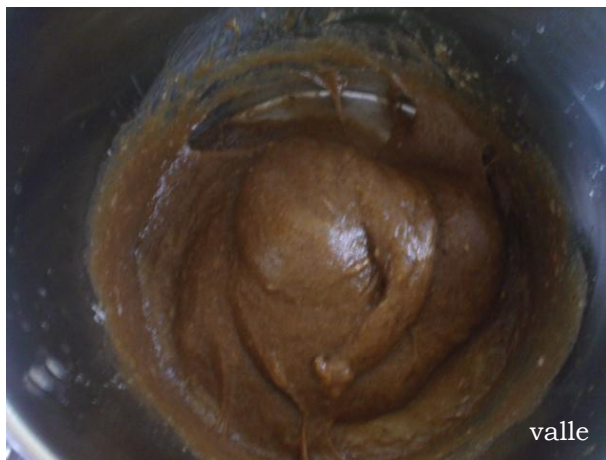
Figura N° 21. Formación de gel de goma xantán en frío e incorporación del bálsamo. El estado de agregación solidó en polvo fino, la dispersión del polvo sobre la superficie del agua y la agitación favorece su hinchamiento.
