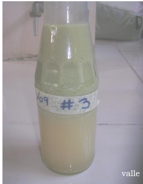
Figura N° 19. Preformulación N° 3: separación evidente de la capa acuosa y de la capa oleosa transcurridos 15 minutos de envasado
