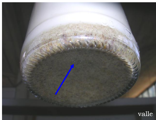
Figura N° 20. Preformulación N° 4. Oleorresina de bálsamo a una concentración del 0.4% y especias sedimentas en el fondo del envase después de 15 minutos de envasado utilizando goma xantán a una concentración del 0.1%.
