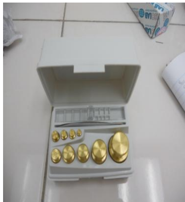
Fig. N°17: Verificación de respuesta de balanza semianalítica
