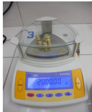
Fig. N°17: Verificación de respuesta de balanza semianalítica
