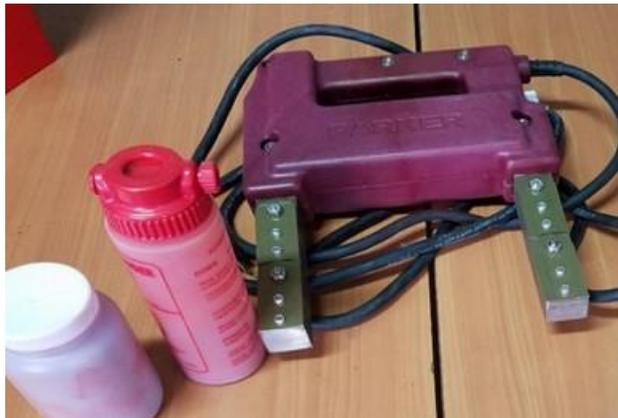
Fig. 2.13. Equipo para utilizar en el ensayo por partículas magnéticas.
