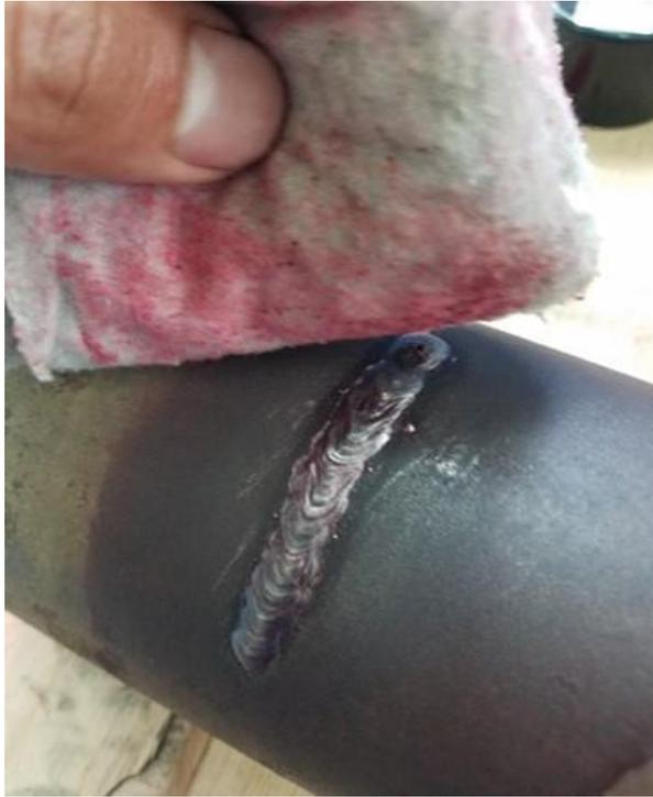
Fig. 3.6. Remoción de líquido penetrante previo a la aplicación del revelador.
