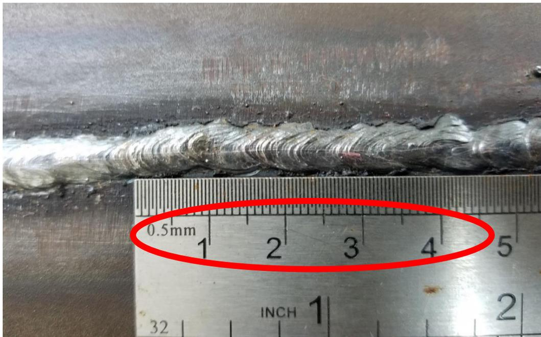
Fig. 4.2. Grieta en el cordón de soldadura.
