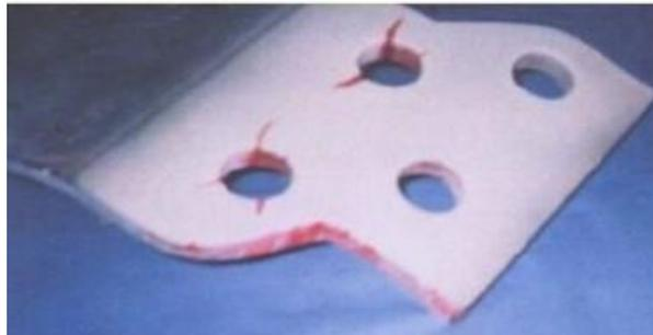
Fig. 2.3. Pieza recubierta con revelador formando un contraste blanco.
