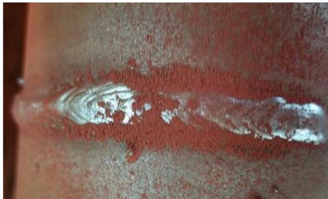
Fig. 4.9. Defectos en un cordón de soldadura, expuestas por partículas magnéticas.
