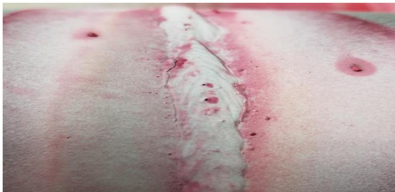
Fig. 3.7. Aplicación del líquido revelador.
