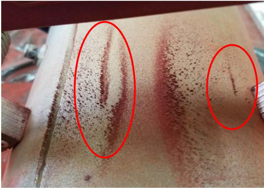
Fig. 4.8. Indicaciones reveladas bajo el método de ensayo por partículas magnéticas.
