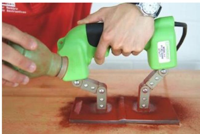
Fig. 1.12. Etapas del método de aplicación de partículas ferromagnéticas.
