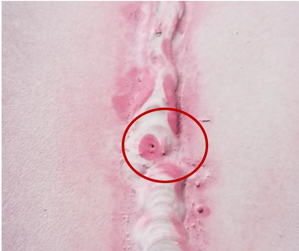
Fig. 4.3. Presencia de un poro en un cordón de soldadura.
