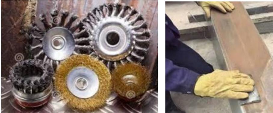
Fig. 2.12. Productos para limpieza de una superficie a ser examinada.
