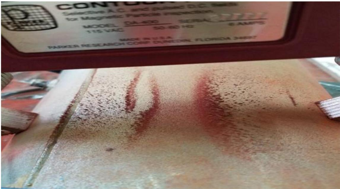
Fig. 3.13. Revelación de las indicaciones que se forman en el ensayo por partículas magnéticas.
