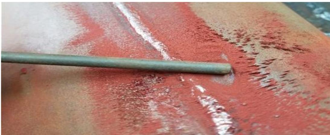
Fig. 3.14. Desmagnetización de la superficie ensayada.
