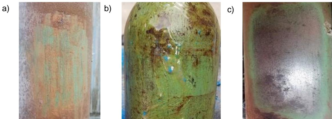
Fig. 3.3. Preparación de la superficie para realizar ensayo por líquidos penetrantes: a) Superficie con óxido; b) superficie con químico removedor de pintura aplicado; y c) superficie completamente limpia.
