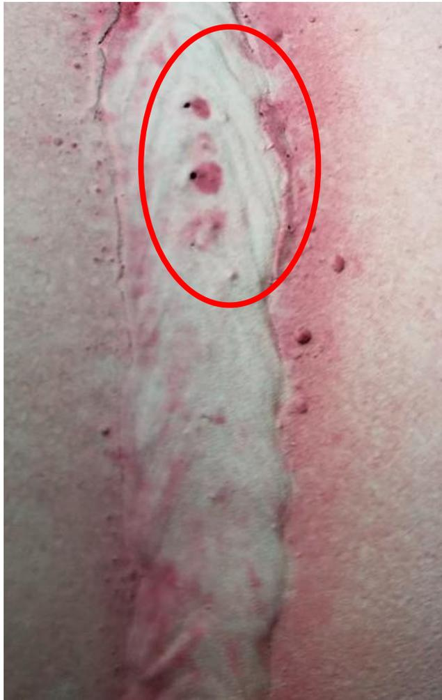
Fig. 4.4. Poros encontrados en el cordón de soldadura.
