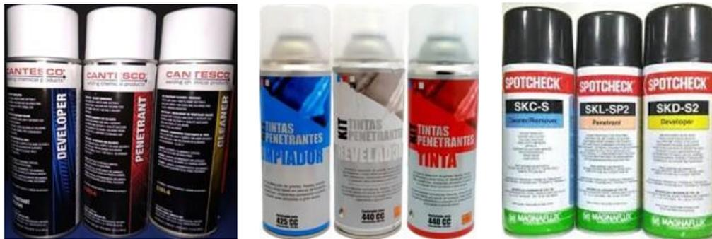
Fig. 2.4. Algunas marcas de los productos para ensayos por líquidos penetrantes.
