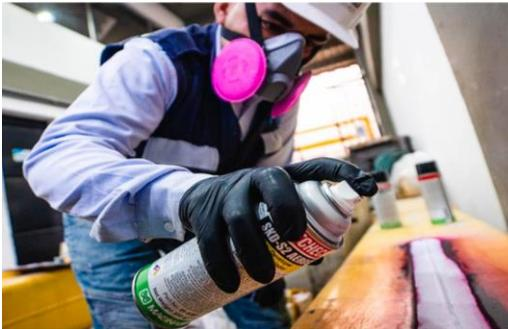
Fig. 1.5. Operario realizando el ensayo por líquidos penetrantes a una pieza de metal que cumple con los requerimientos para realizar el ensayo no destructivo.
