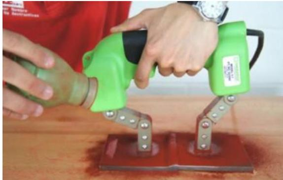
Fig. 1.8. Realización del ensayo por partículas magnéticas utilizando un yugo Y-2 de corriente alterna de patas articuladas.
