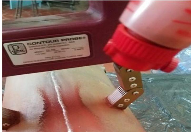
Fig. 3.12. Forma de esparcir las partículas ferromagnéticas.
