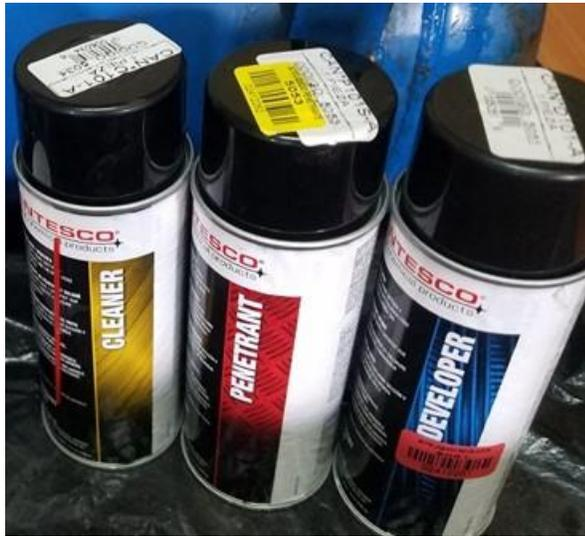
Fig. 2.5. Productos de la marca CANTESCO utilizados para ensayo por líquidos penetrantes.
