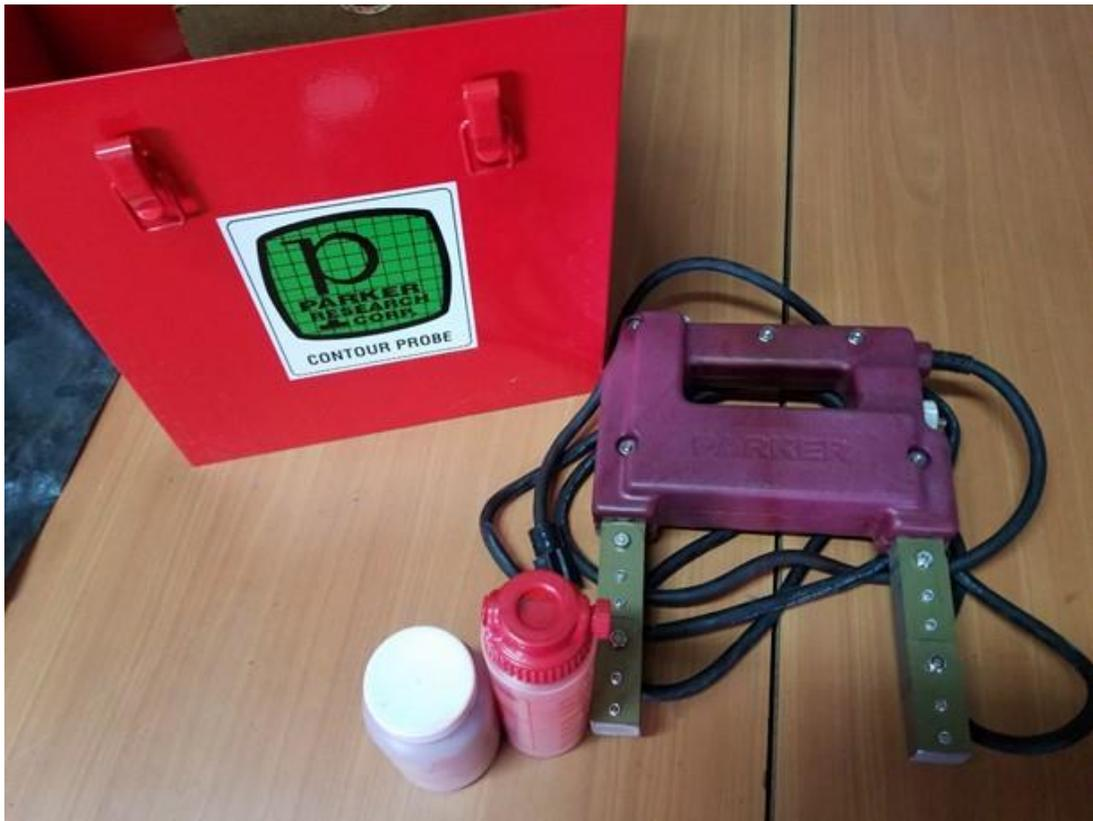
Fig. 3.2. Equipo para realizar el ensayo por partículas magnéticas.
