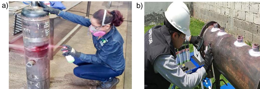
Fig. 1.7. Diferentes posiciones en la que se puede colocar la pieza a ensayar: a) Vertical; y b) horizontal.
