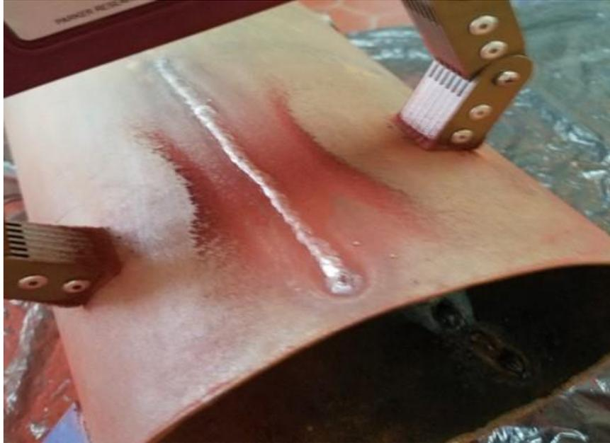
Fig. 4.15. Evidencia de defectos en el material inspeccionado.
