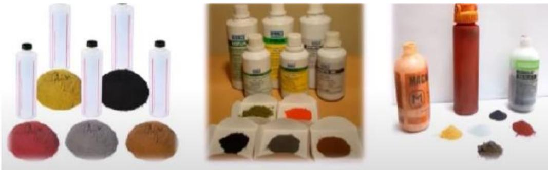
Fig. 2.6. Polvos de partículas ferromagnéticas utilizadas para la prueba no destructiva.
