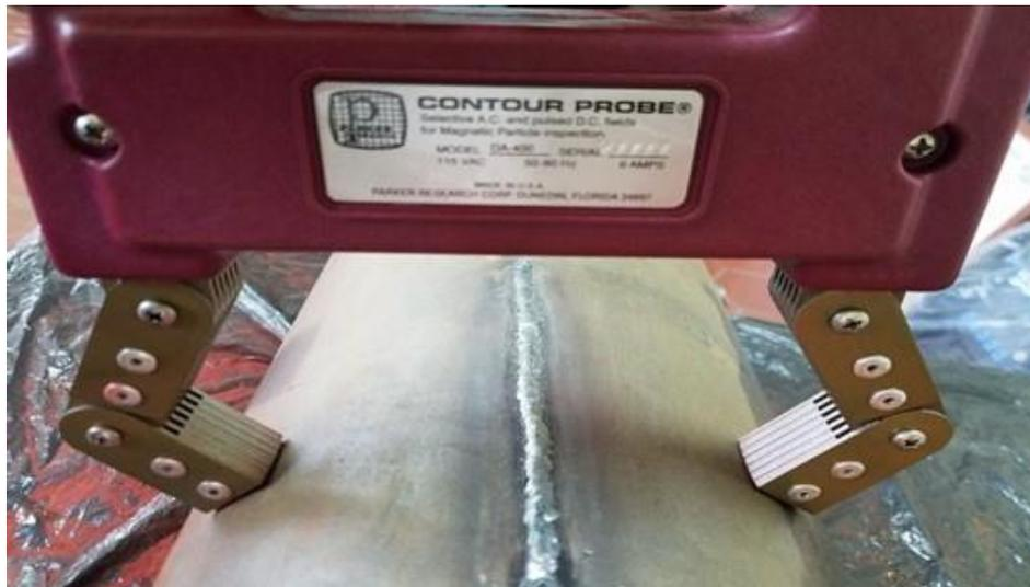
Fig. 3.10. Posicionamiento de las patas articuladas del yugo magnético.
