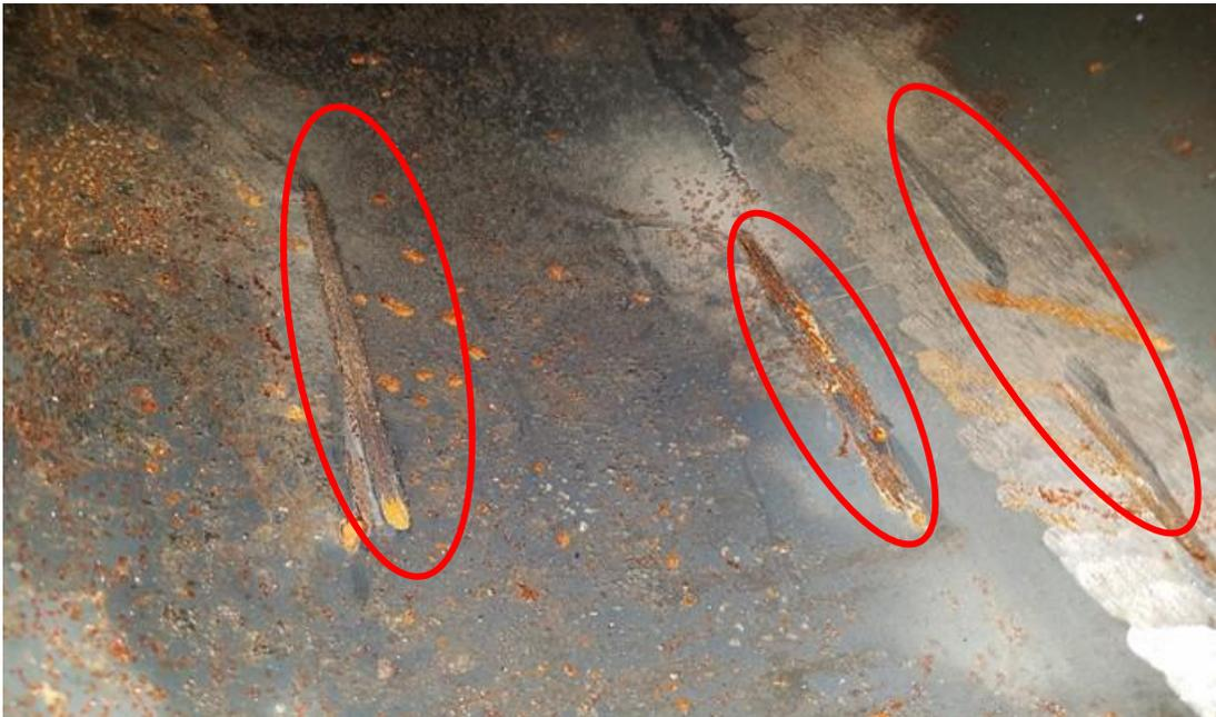
Fig. 4.14. Grietas inducidas en la parte interna del recipiente a presión.
