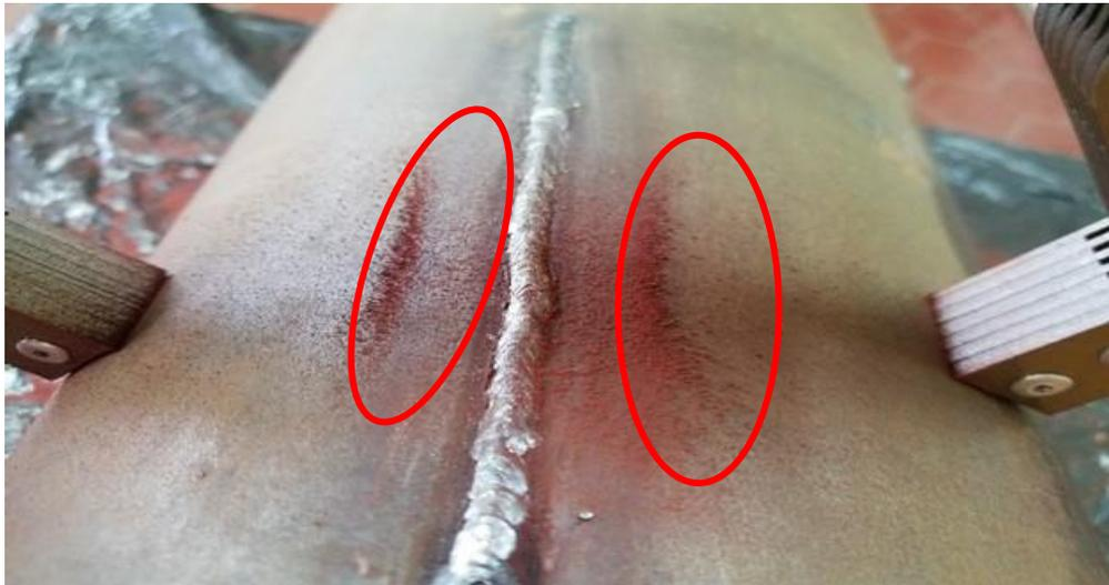
Fig. 4.16. Fisuras detectadas por partículas magnéticas.
