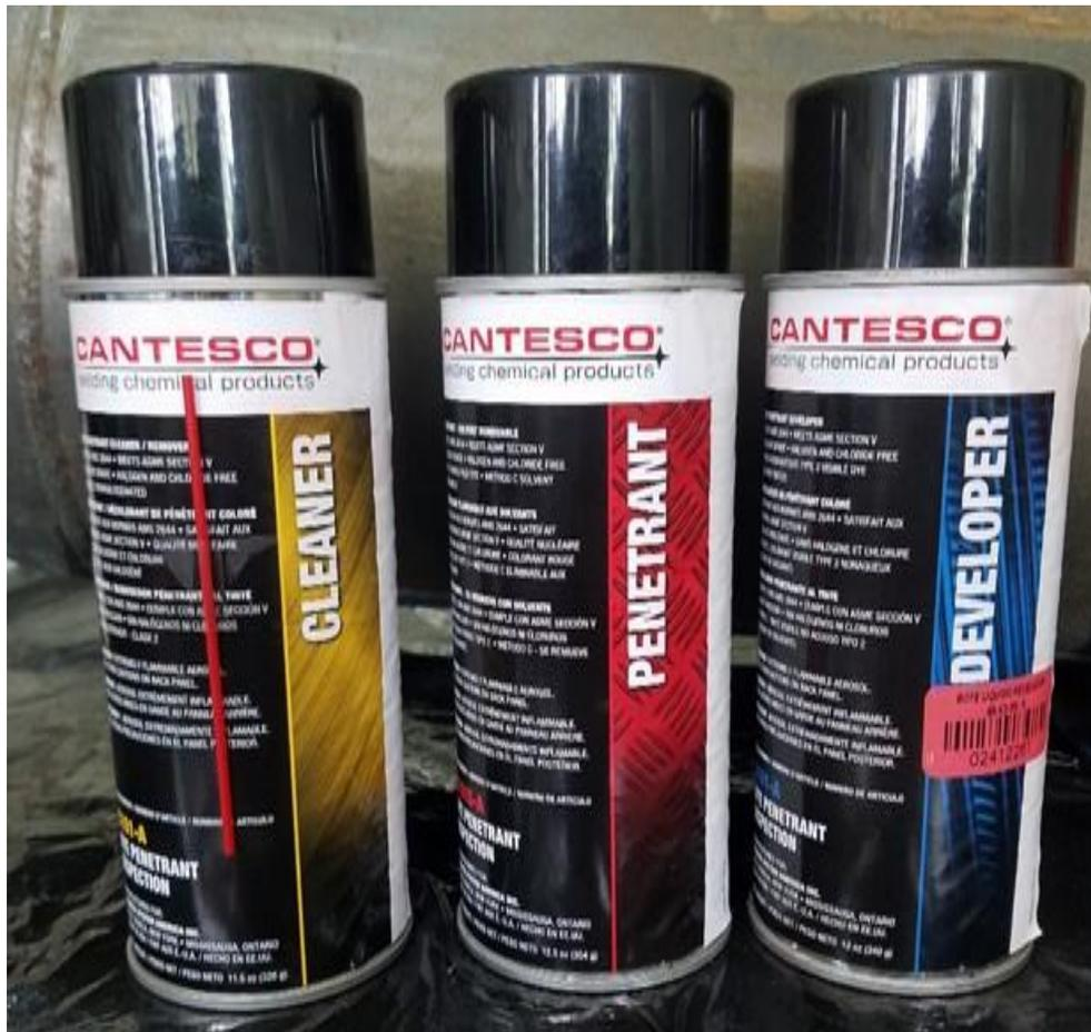
Fig. 3.1. Productos de la marca CANTESCO para la realización del ensayo no destructivo por tintes penetrantes.
