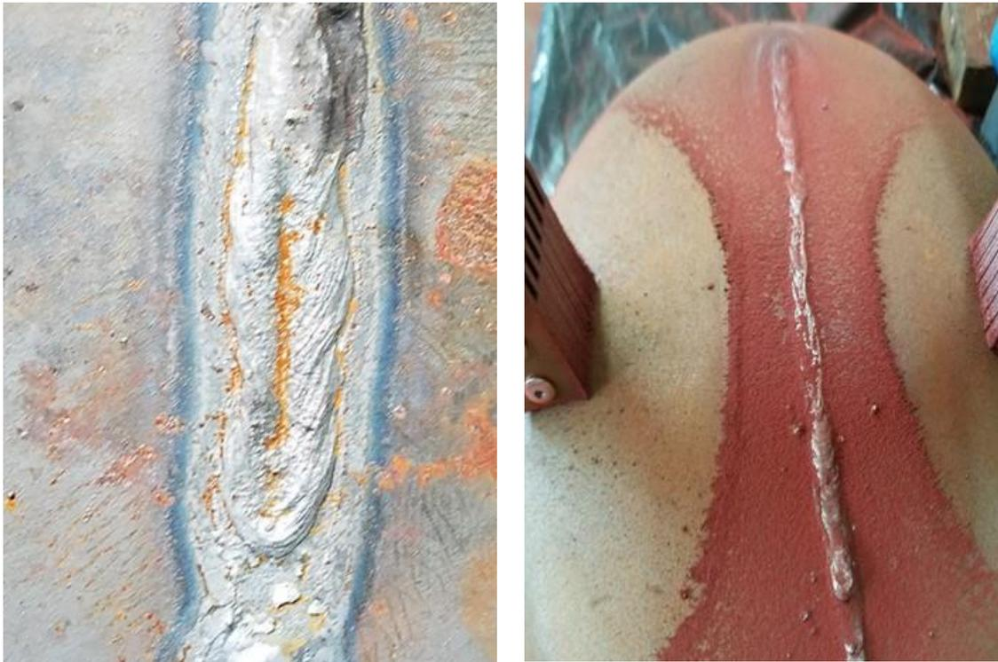
Fig. 4.12. Defecto inducido a una de las tapaderas del recipiente a presión: a) Defecto inducido; y b) defecto reflejado por las partículas magnetizadas.
