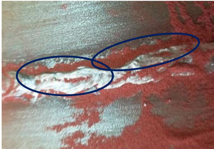
Fig. 4.13. Defectos inducidos a tapadera de recipiente a presión.
