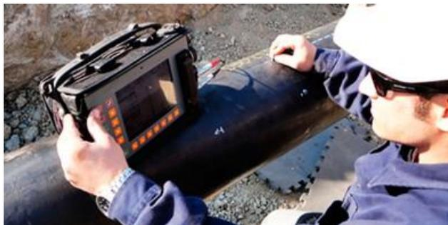
Fig. 1.3. Inspección volumétrica.
