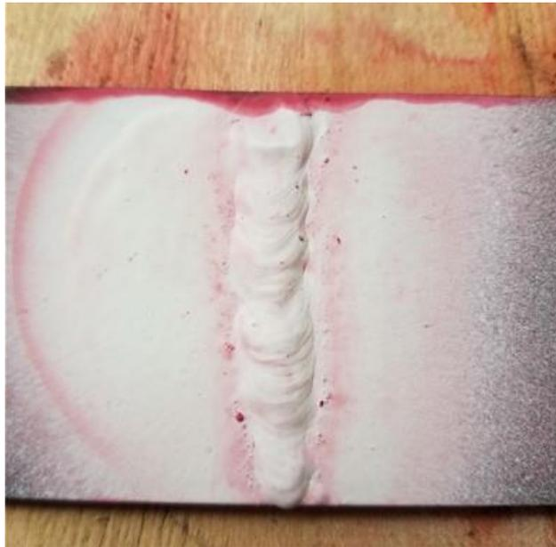
Fig. 4.5. Cordón de soldadura sin defectos.
