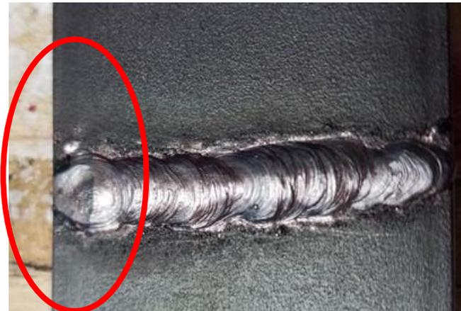
Fig. 4.6. Cordón de soldadura realizado a una muestra de prueba.
