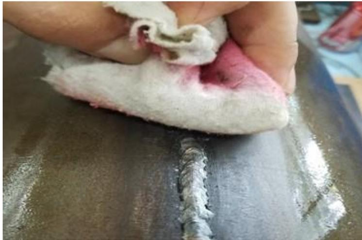
Fig. 3.8. Limpieza final del ensayo por líquidos penetrantes.
