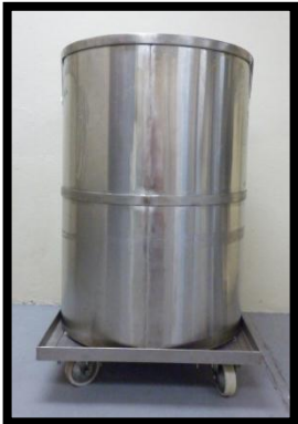
Fig. N° 3 Tanque de acero inoxidable de capacidad de 149 L.
