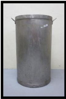
Fig. N° 2 Tanque de acero inoxidable de capacidad de 99 L.
