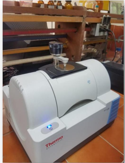
**Figura 29.** Espectrofotómetro IR NICOLET iS5 (Thermo SCIENTIFIC)
