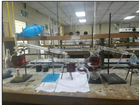
**Figura 17.** Destilación del biodiésel
