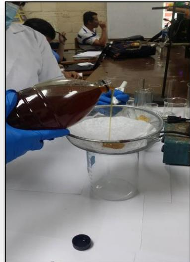
**Figura 12.** Filtración por gravedad del aceite usado
