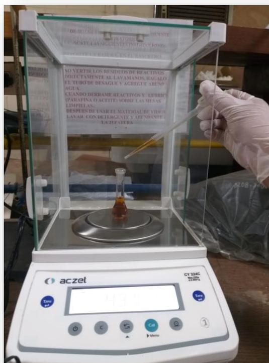
**Figura 24.** Balanza Analítica (Aczet CY 224C)
