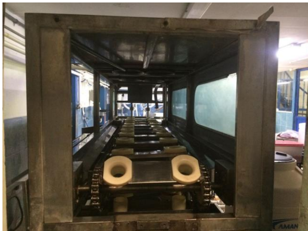
Parte de atrás de la llenadora (se hace lavado de garrafón por la máquina segundo lavado)
