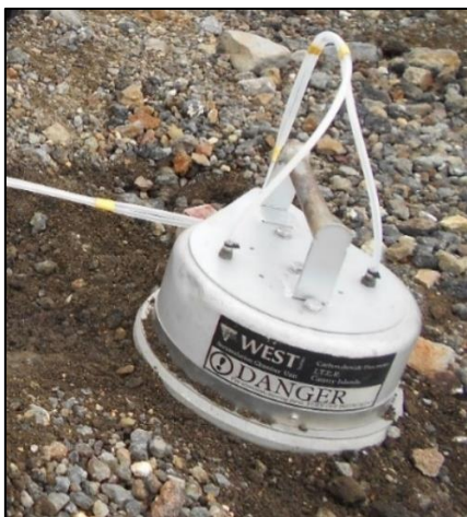
Cámara de acumulación enterrada
