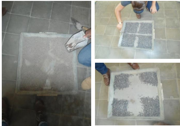
a) Cuarteo de agregado fino y grueso para ensayos de granulometría.
