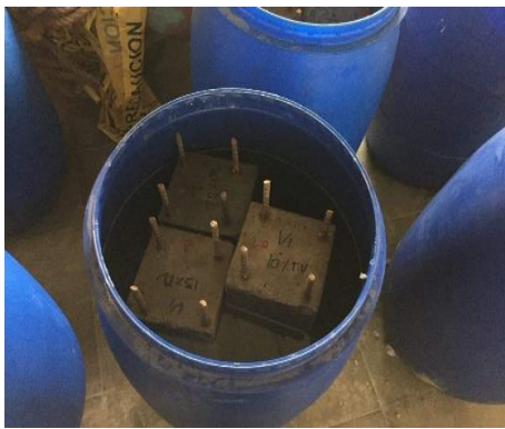
a) Inmersión de viguetas en agua de mar. b) Secado de viguetas en ambiente de laboratorio.
