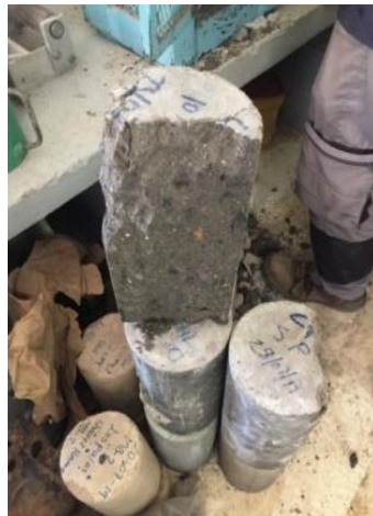
b) Fallas de cilindros después de ensayos a compresión.
