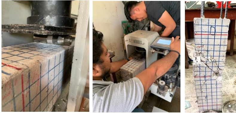
Aplicación de carga en la máquina de ensayo de flexión.
