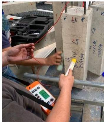
Fotografía 3.10: Esquema para ensayo de potencial de corrosión.
