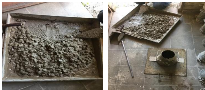
a) Muestreo del concreto y preparación del cono de revenimiento.
