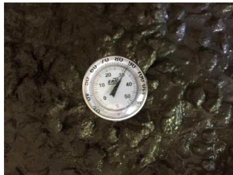
Fotografía 3.6: Ensayo de temperatura con termómetro de vástago.
