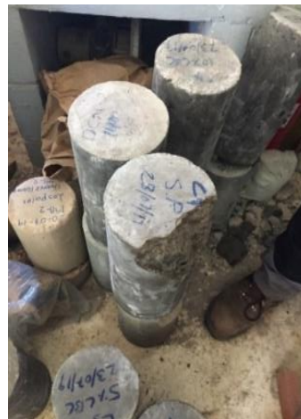
b) Fallas de cilindros después de ensayos a compresión.
