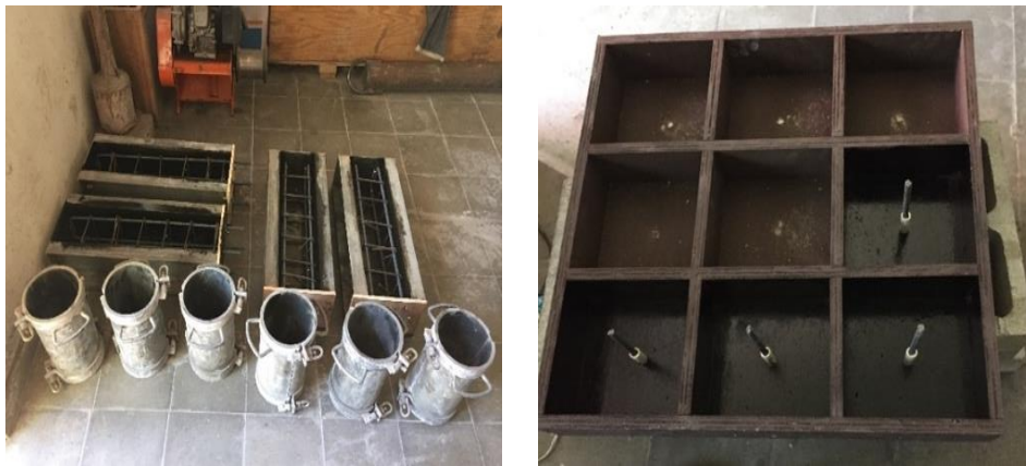
a) Preparación de moldes para especímenes de ensayo a compresión, flexión y arrancamiento.
