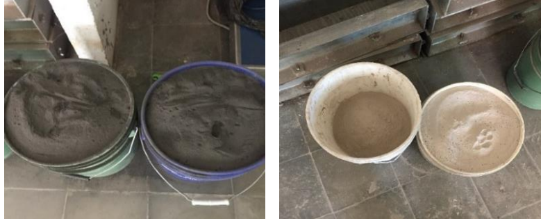
c) Obtención del material puzolánico que fue usado en la sustitución de cemento, aquel que se retiene y pasa el tamiz No. 200.
