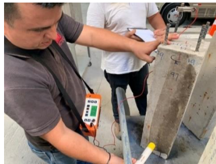
e) Medición de potencial de corrosión.
