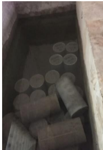
a) Curado y ensayo a la compresión de cilindros.
