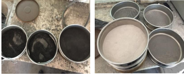
b) Reducción del tamaño de las partículas del material puzolánico utilizando tamices No. 50, No. 100 y No. 200.
