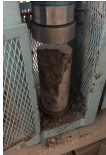
a) Curado y ensayo a la compresión de cilindros.
