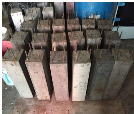
a) Inmersión de viguetas en agua de mar. b) Secado de viguetas en ambiente de laboratorio.
