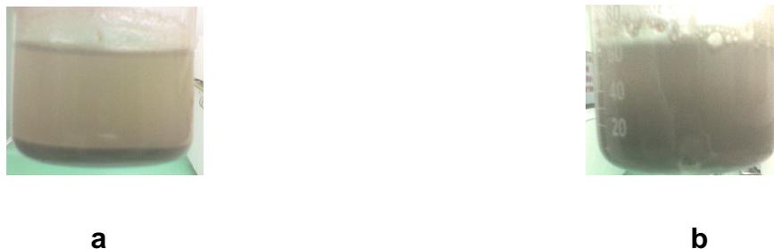
**Figura N° 4 Muestra con sal de hierro al fondo(a) y muestra con la sal de hierro mezclada con la horchata (b)**
