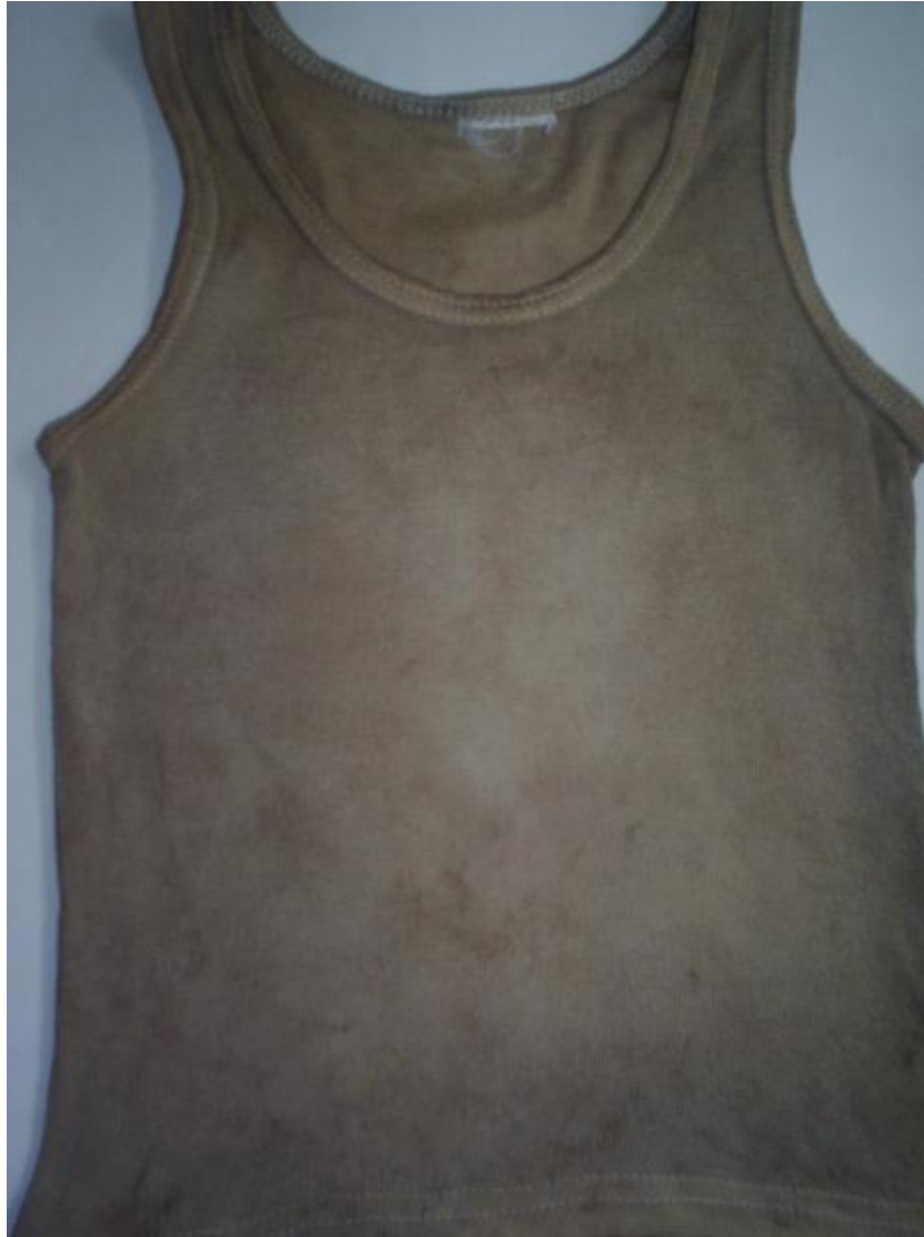
Fig. N° 32 PRENDA DE ALGODON TEÑIDA CON EL COLORANTE DE LA CASCARA DE PLATANO UTILIZANDO COMO MORDIENTE SOLUCION SATURADA DE ACIDO TANICO
