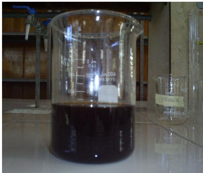
Fig. N° 22 EXTRACTO DEL COLORANTE OBTENIDO POR MEDIO DE LA TECNICA DEL REFLUJO
