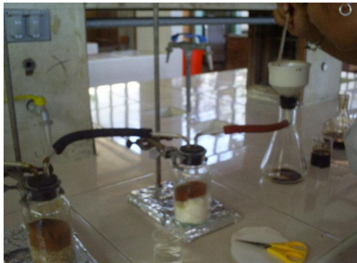
Fig. N° 17 PROCESO DE FILTRACION AL VACIO DEL COLORANTE
