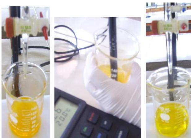
**Figura N°21** **A:** Inicio de la titulación 20.0 ml de Ácido Clorhídrico 0.1M y 1 mL del extracto etanólico de *Bixa orellana* Linn. (ACHIOTE) coloración anaranjada.
