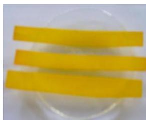
**Figura N°17** Papel indicador utilizando extracto obtenido por Método de Soxhlet, con Alcohol Etilico al 90% AR, de *Bixa orellana Linn.* (ACHIOTE) en proceso de secado.
