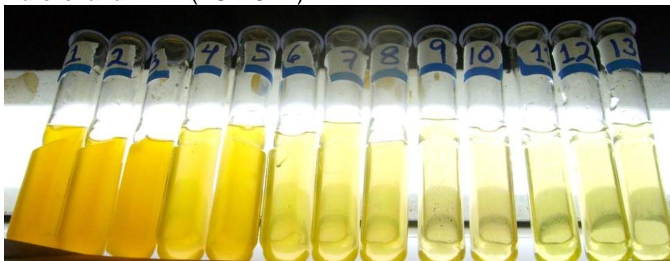
**Figura N°16** Escala de pH obtenida a partir del extracto obtenido por Método de Soxhlet, con Alcohol Etílico al 90% AR de *Bixa orellana Linn.* (ACHIOTE).
