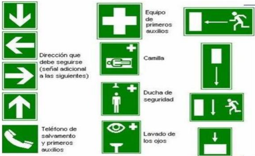
Imagen N° 7: Señal de Seguridad, salvamento o auxilio.
