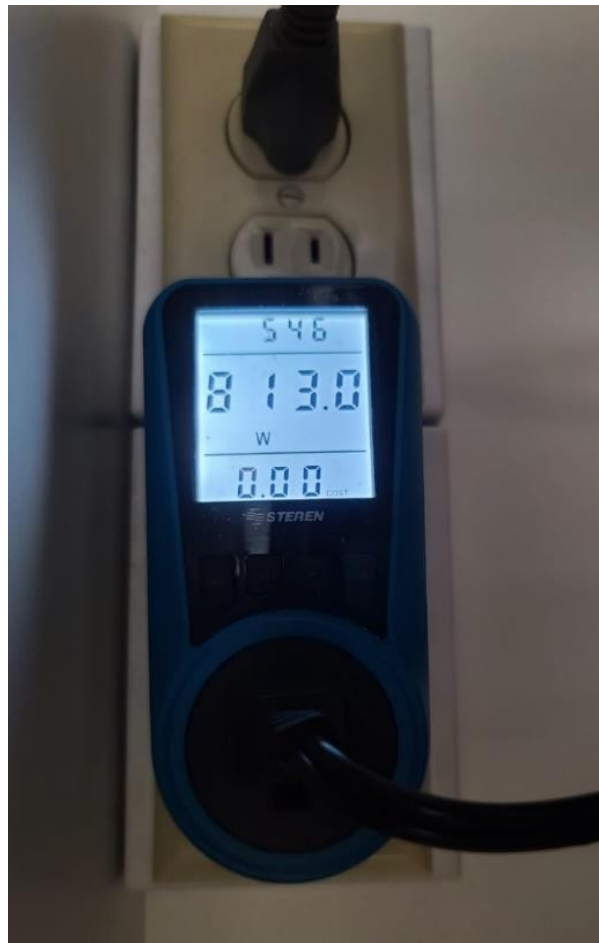
Figura 1.6 Medidor portátil de energía y potencia HER-432 con el cual se realizó las mediciones de potencia y energía que consume cada equipo electrónico en la Torre PGR San Salvador. Fuente Propia
