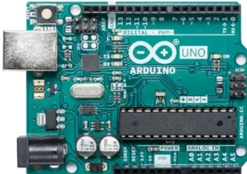
Fig. 2.8. Placa de Arduino UNO [16].
