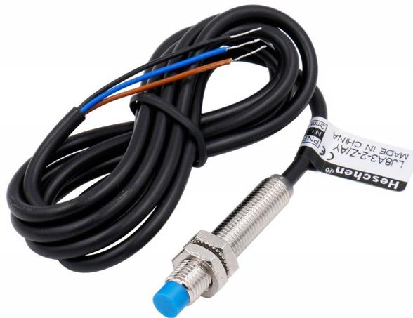
Fig. 3.1. Sensor inductivo tipo PNP, cable marrón positivo, azul negativo y negro señal [33].
