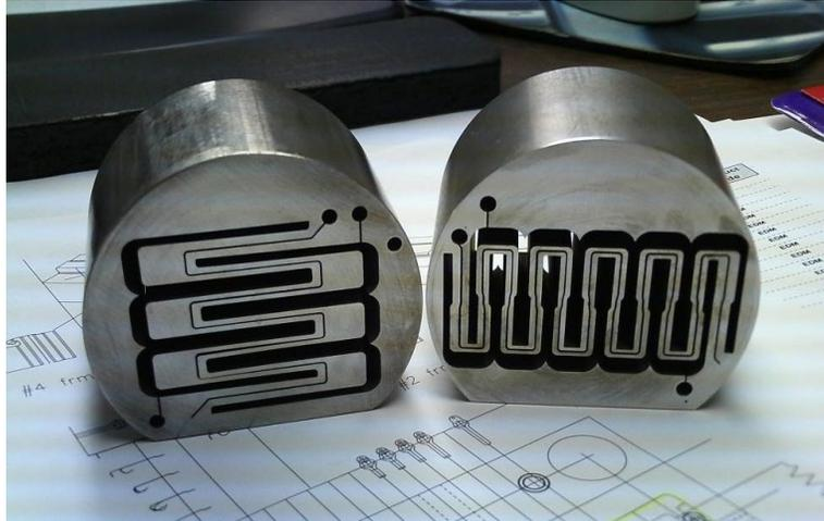
Fig. 1.18. Aleación Inconel 718 mecanizada mediante electroerosión por hilo.
