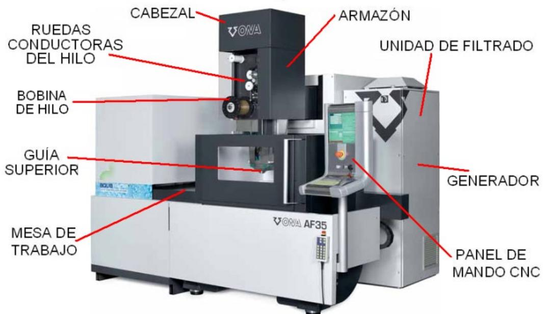
Fig. 1.14. Componentes de una máquina de electroerosión por hilo [2].
