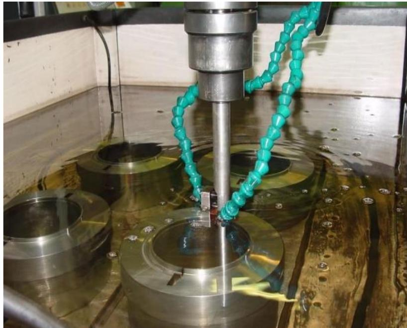
Fig. 1.17. Maquinado de un acero Sverker 21 mediante electroerosión.
