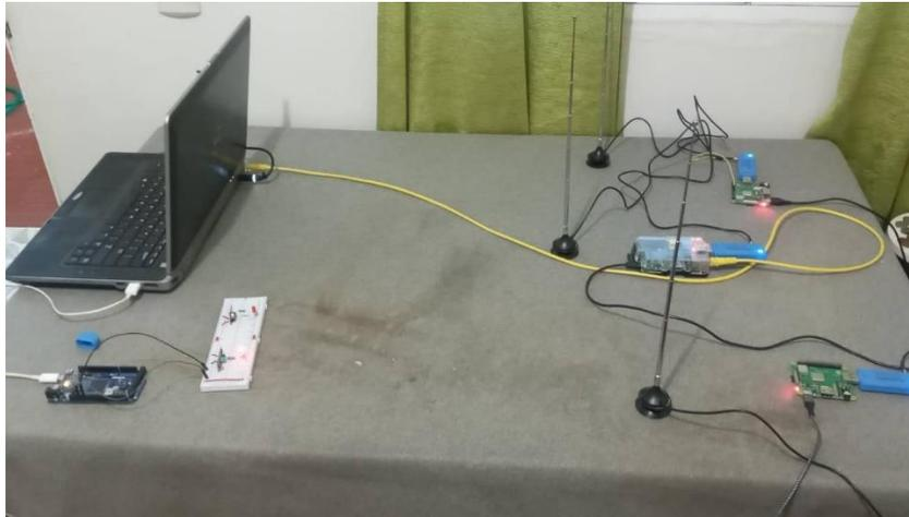
*Ilustración 58: Estaciones receptoras (Raspberry Pi junto a dongle RTL-SDR y antena monopolo) y estación maestra (Laptop Dell).*
