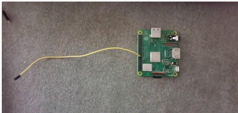
*Ilustración 41: Raspberry Pi como transmisor, la antena de transmisión es el jumper de color amarillo.*
