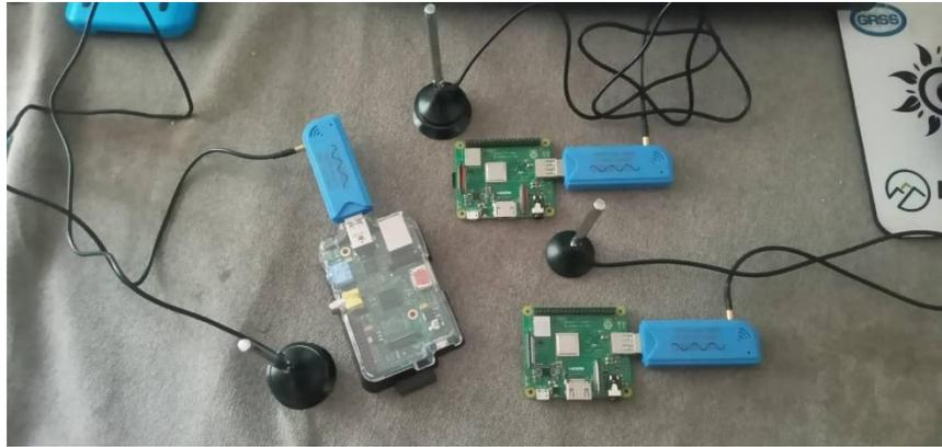
*Ilustración 49: 3 estaciones receptoras conformadas por Raspberry Pi 3 A+ y dongle RTL-SDR mini 2+.*
