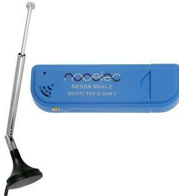
*Ilustración 40: Dongle RTL-SDR para capturar y detectar señales de radio frecuencia.*
