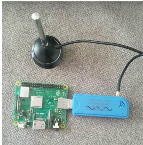
*Ilustración 48: Estación receptora de bajo costo.*
