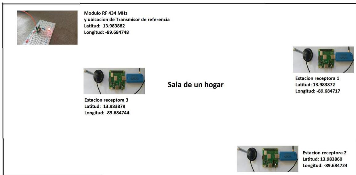
Ilustración 71: Despliegue de estaciones receptoras Raspberry Pi.
