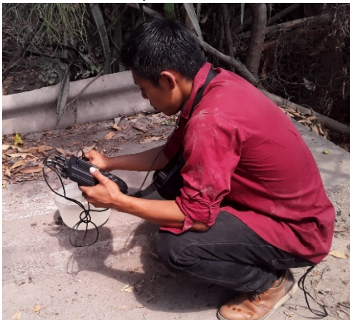
Anexo 10. Análisis en campo con sonda multiparamétrica.
