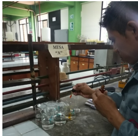
Anexo 17. Adición de anaranjado de Metilo (prueba de sulfatos).
