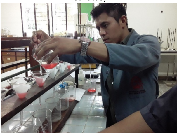
Anexo 20. Filtrado de muestra (prueba de sulfatos)
