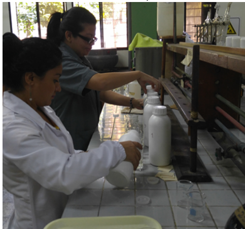
Anexo 16. Medición de muestra (prueba de sulfatos).
