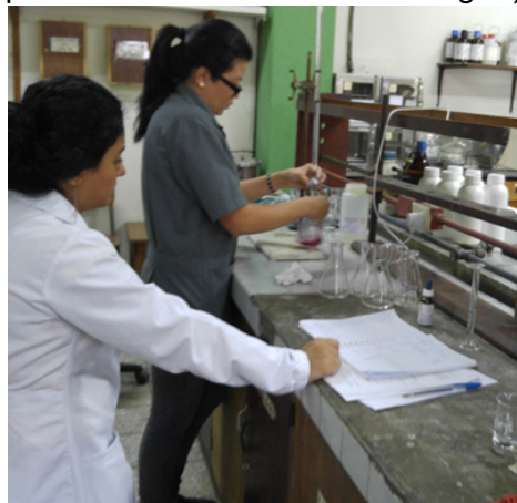
Anexo 13. Titulación de dureza (prueba para determinar la dureza del agua).
