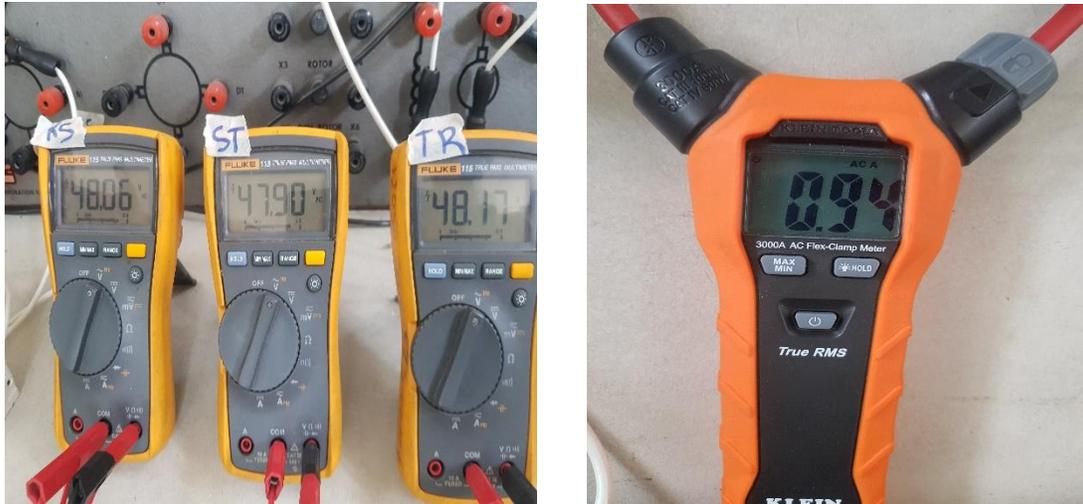
Figura 4.113 Medición de voltajes de línea a línea y corriente de línea a la entrada del motor para la fase R.
