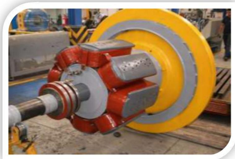
Figura 2.5 Rotor de polos salientes. (De la torre, Sf)
