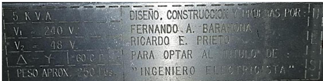
Figura 4.65 Placa característica del transformador trifásico 5KVA.
