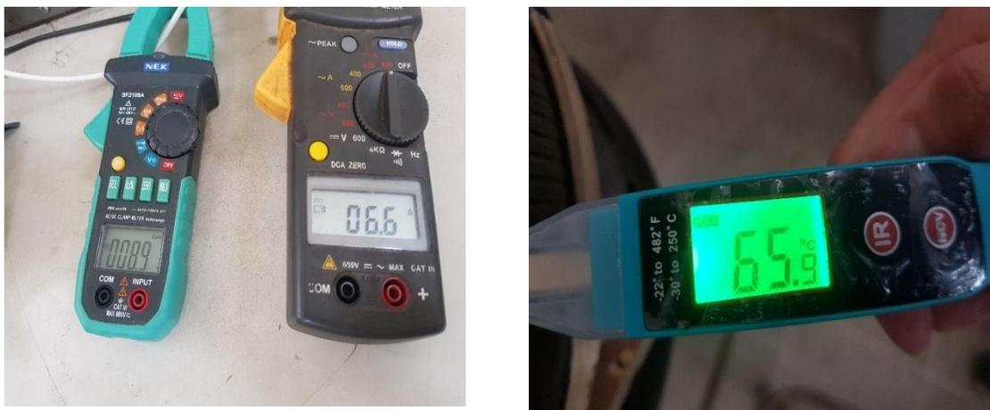
Figura 4.116 Medición de la corriente de excitación del campo del alternador durante la prueba, y medición de la temperatura del reóstato al final de la prueba.
