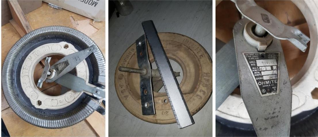
Figura 4.100 Reóstato marca OHMITE de  $20\Omega$  disponible en el laboratorio de máquinas eléctricas de la EIE-UES.
