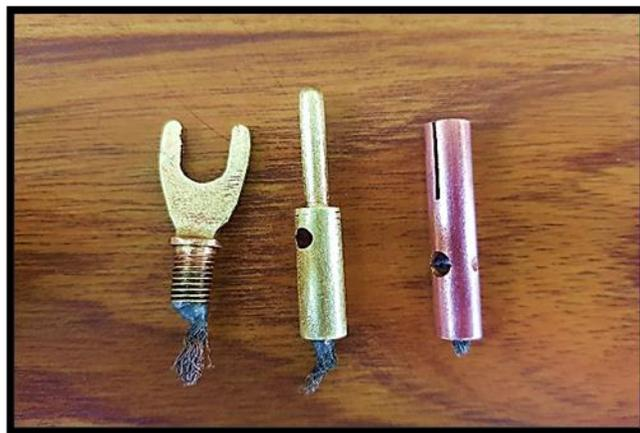
Figura 4.30 Conectores tipo gancho, banana, hembra después del procedimiento de limpieza.
