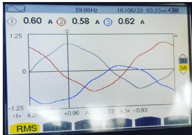
Figura 4.71 Corriente de fase del motor.
