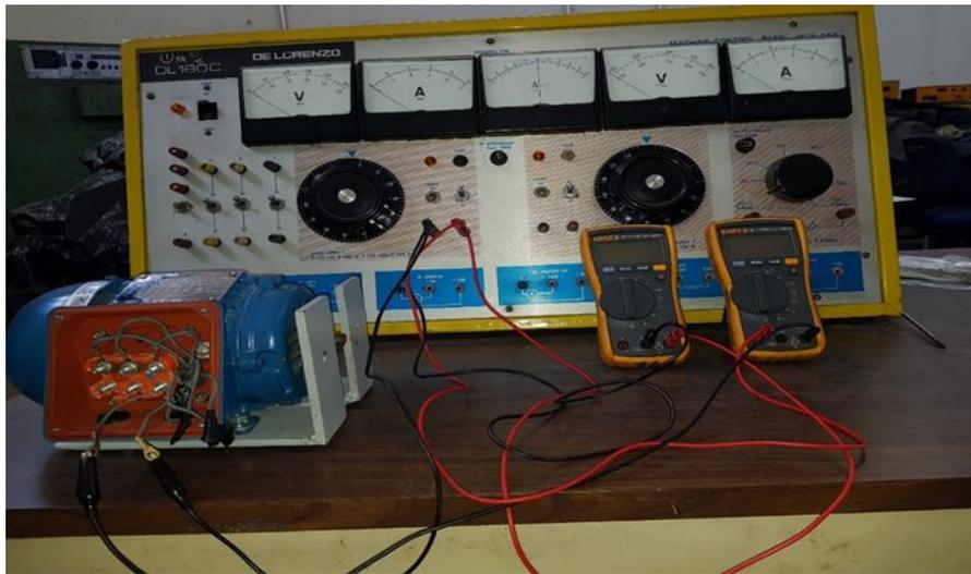
Figura 4.53 Montaje practico de la prueba DC.
