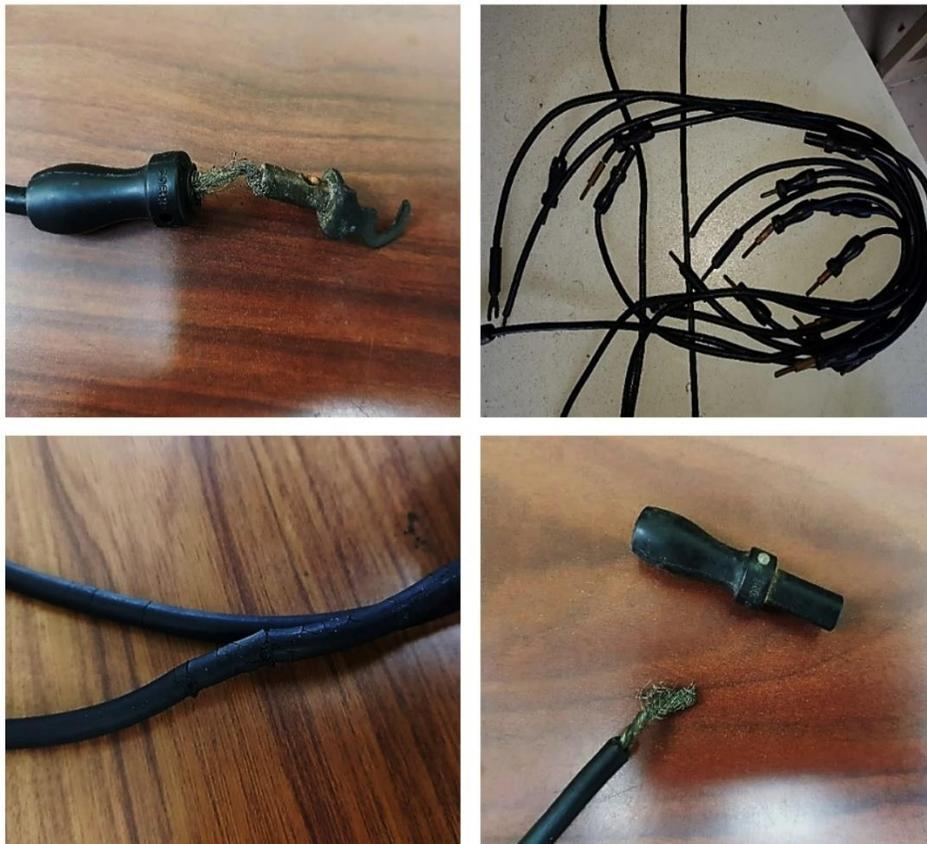
Figura 4.28 Cables, conector tipo gancho y hembra en mal estado.
