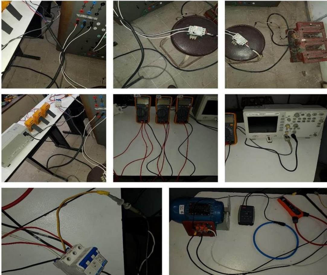
Figura 4.72 Montaje definitivo para el ensayo de vacío, utilizando el osciloscopio Agilent Technologies modelo DS01012A como el único instrumento de medición.
