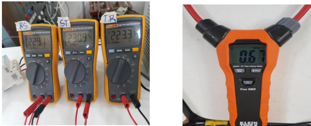
Figura 4.80 Voltaje de línea a línea, corriente de fase, para la FASE T a 230V.
