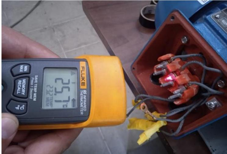
Figura 4.52 Medición de la temperatura final en el neutro.
