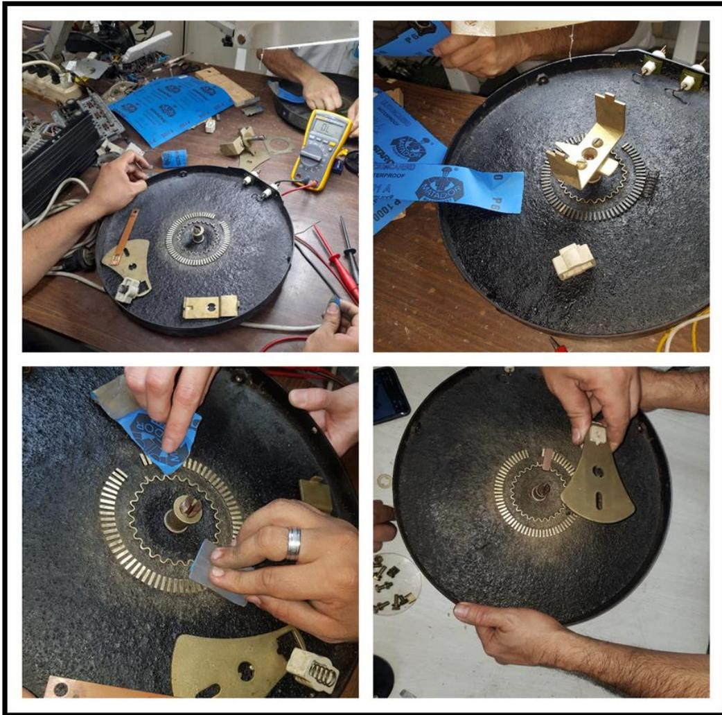
Figura 4.34 Lijando partes del reóstato.
