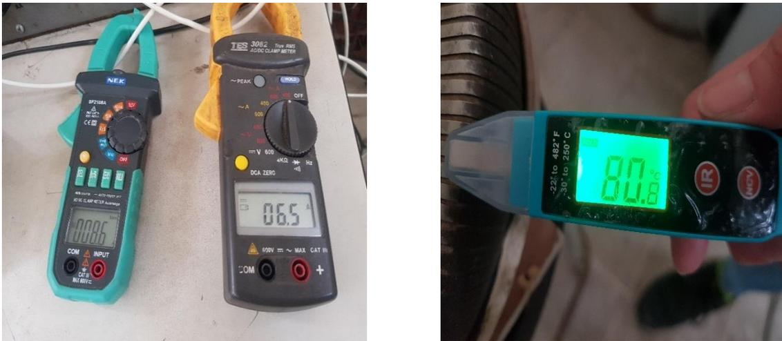
Figura 4.120 Medición de la corriente de excitación del campo del alternador durante la prueba, y medición de la temperatura del reóstato al final de la prueba.
