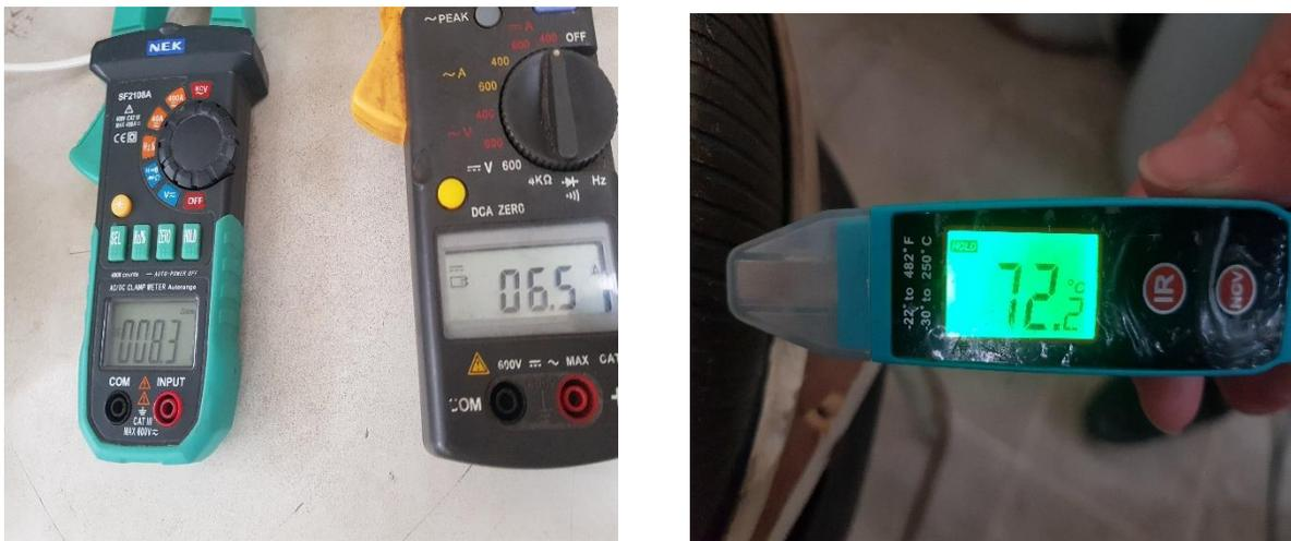
Figura 4.112 Medición de la corriente de excitación del campo del alternado durante la prueba, y medición de la temperatura del reóstato al final de la prueba.
