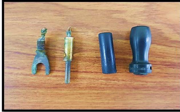
Figura 4.29 Conector gancho - banana, y su respectivo protector aislante separado previo al procedimiento limpieza.
