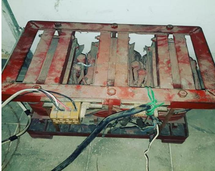
Figura 4.64 Transformador trifásico a utilizar en la prueba de vacío.
