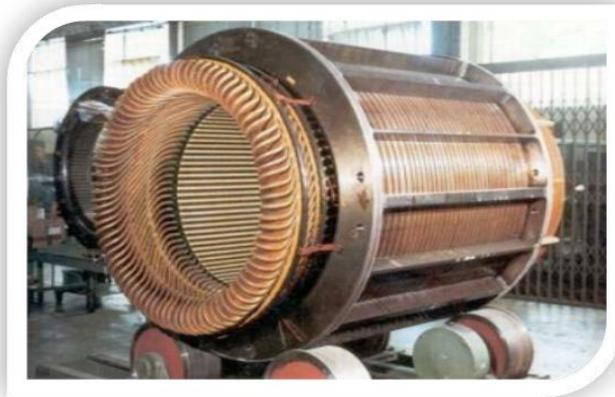
Figura 2.1 Estator de un alternador en construcción. (De la torre, Sf)
