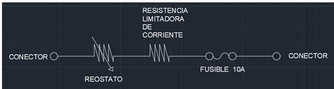
Figura 4.21 Diagrama unifilar del reóstato de campo de la maquina universal. (System Hampden, Sf)
