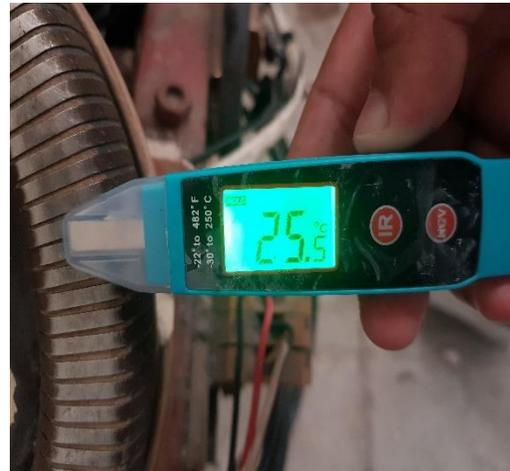
Figura 4.108 Medición de la resistencia y la temperatura inicial del réostato de armadura del motor DC.
