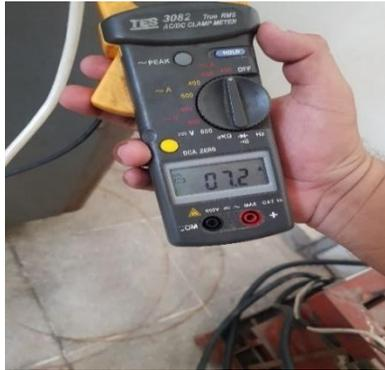
Figura 4.121 Medición de la corriente total consumida por el alternador.
