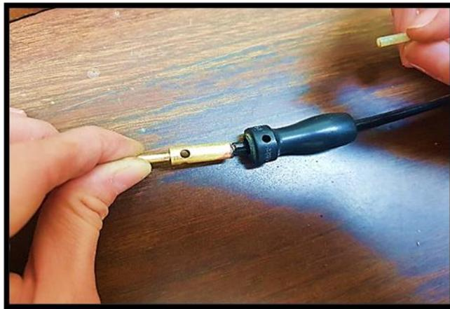
Figura 4.31 Ensamblando conector banana.
