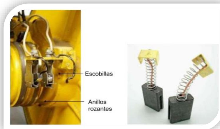
Figura 2.3 Escobillas de grafito y anillos deslizantes. (De la torre, Sf)
