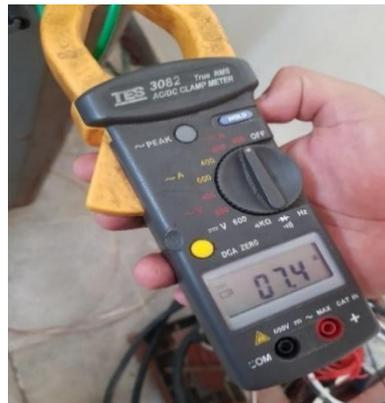
Figura 4.122 Medición de la corriente total consumida por el motor DC.
