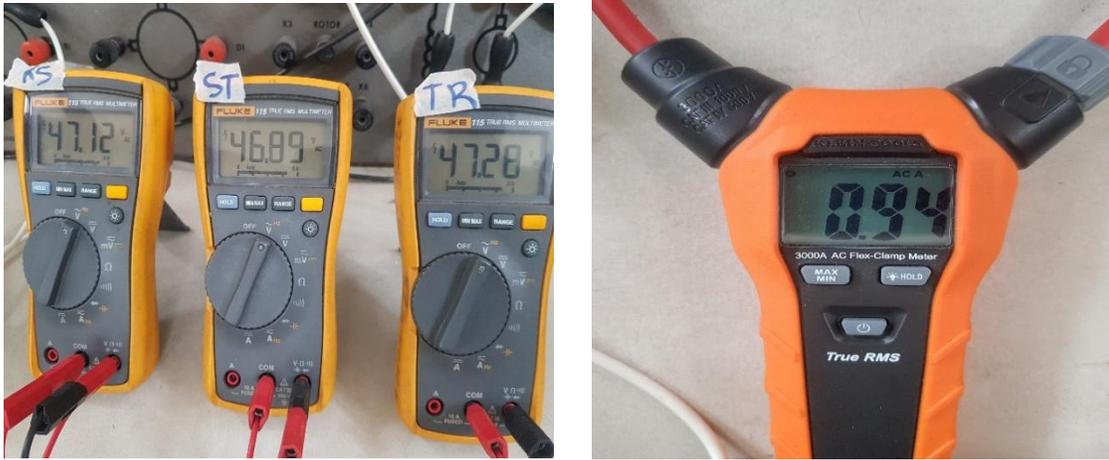
Figura 4.117 Medición de voltajes de línea a línea y corriente de línea a la entrada del motor para la fase T.
