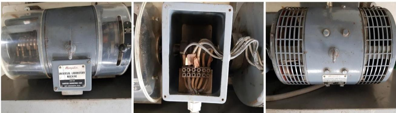
Figura 4.92 motor universal (figura de la izquierda), muñón de acoplamiento y conexiones eléctricas (figura al medio), Generador de corriente continua (figura de la derecha).
