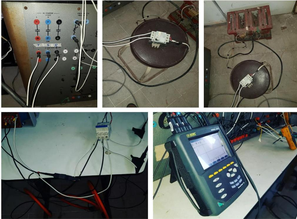
Figura 4.69 Montaje parcial para el ensayo de vacío, utilizando el analizador de redes eléctricas aemc instrument modelo 8336 como el único instrumento de medición.
