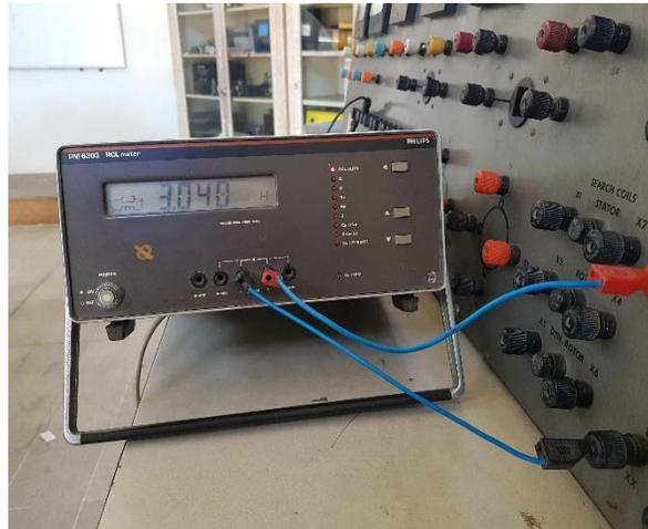
Figura 4.95 Medición de la inductancia del bobinado de campo del motor DC con el RCL meter.
