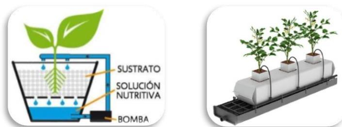
Ilustración 18. Izquierda: Sistema de reflujó mediante bomba. Derecha: Sistema hidropónico de goteo con bandeja recolectora para la recirculación.
