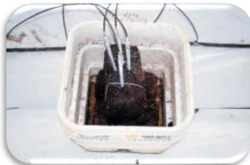
Ilustración 28. Hidratación de ladrillos comprimidos de fibra de coco.
